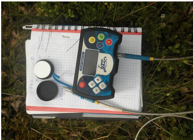
Figure VIII-10: Photographie du spectromètre Jaz-S (Oceanoptics) et de son spectralon blanc pour l'étalonnage entre chaque prise de mesure radiométrique. Crédits: R. Courault 2016
