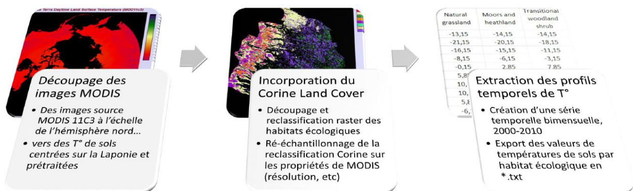
Figure IV-7 : Méthodologie d'extraction de séries temporelles de températures en surface de sol issues des images MODIS 11C3
