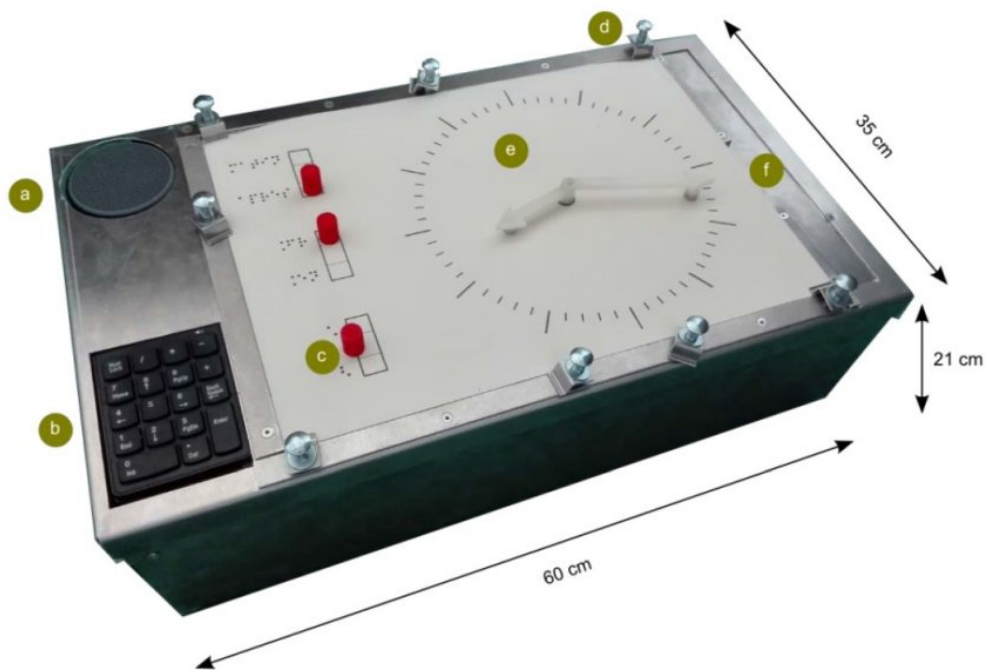
FIGURE 16 – Vue d'ensemble de la Tangible Box. A. Haut-parleur. B. Pavé numérique. C. Pions manipulables par l'utilisateur. D. Surface d'interaction. Ici recouverte d'un papier thermogonflé, mais de nombreux support d'épaisseurs variées sont utilisables. E. Système de fixation du support à hauteur réglable. F. Zone de rangement des pions inutilisés
