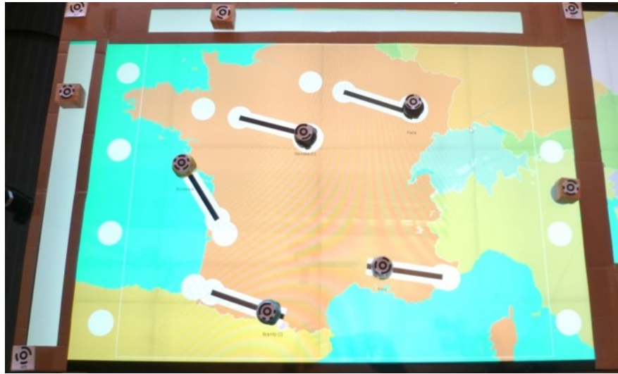
FIGURE 24 – La position des Ozobots sur la carte est mise à jour en affichant un motif lumineux permettant de les diriger vers la nouvelle position de la ville qu'ils représentent, vers une nouvelle ville ou vers une aire de stockage
