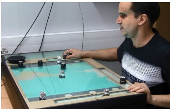
FIGURE 23 – Botmap : les éléments de la carte sont représentés par des robots autonomes qui peuvent se déplacer indépendamment pour simuler des opérations de défilement et de zoom sur une carte
