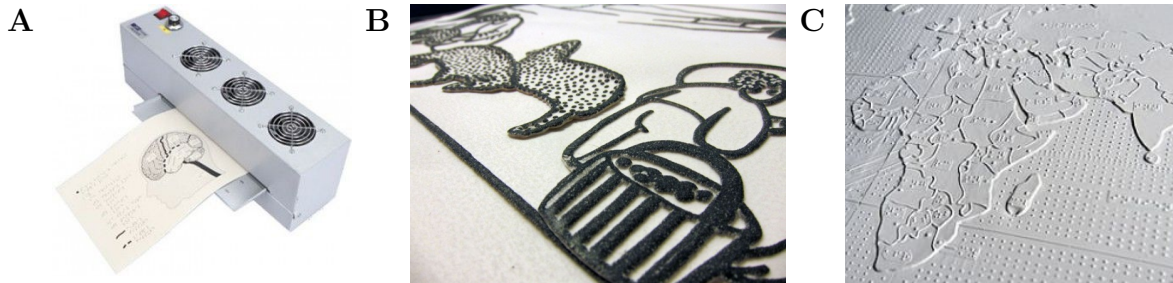
FIGURE 7 – Documents en relief statiques. A) Four à lampe pour papier thermogonflable. B) Relief apparent sur du papier thermogonflé. C) Carte du monde en plastique thermoformé
