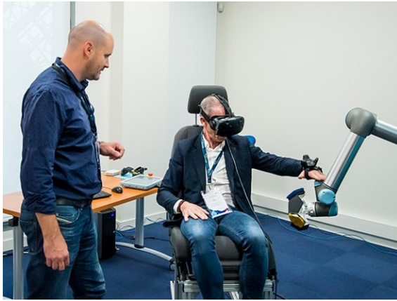
FIGURE 42 – Le projet Lobby-Bot, dans lequel un bras robotisé vient positionner une surface congruente en position, orientation et texture avec une surface présente dans l'environnement virtuel
