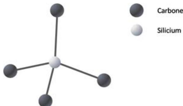
FIGURE 1.18: Représentation schématique d'une maille élémentaire de SiC
