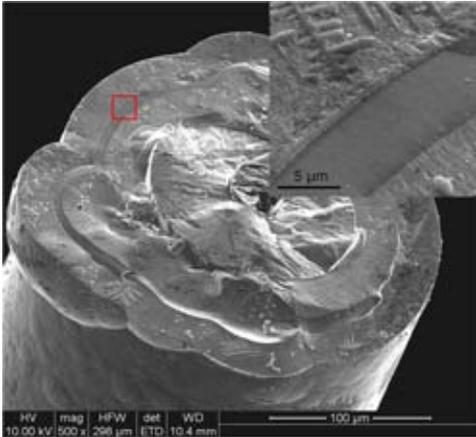
FIGURE 6.2: Faciès de rupture d'un microcomposite 1
