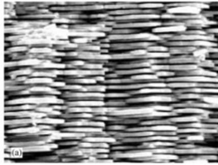
FIGURE 1.1: Image en Microscopie électronique de la structure de la nacre [7]
