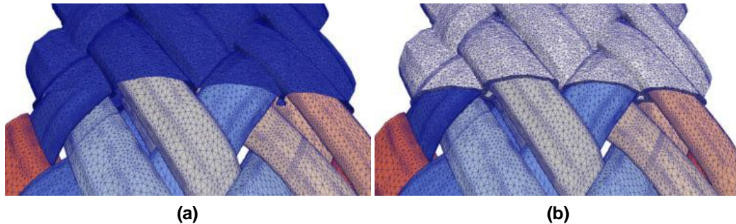
Figure 4.24 - (a) Exemple de maillage surfacique de la matrice avec le maillage des fils et (b) exemple de maillage 3D complet de la structure.
