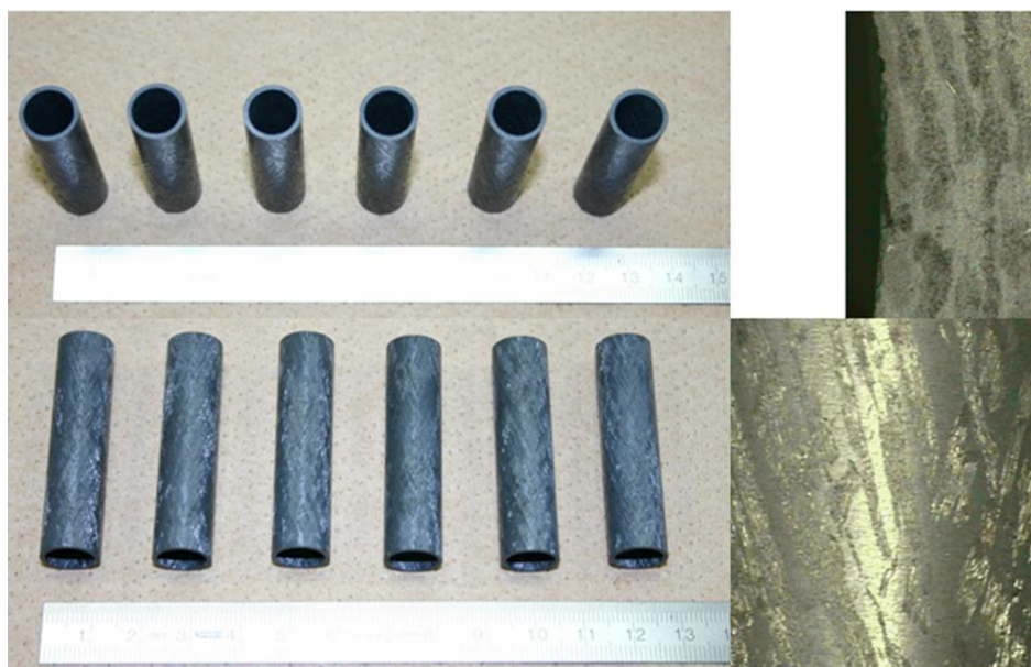
Figure 1.7 - Exemple de composites NITE sous forme tubulaire [KAT 07].
