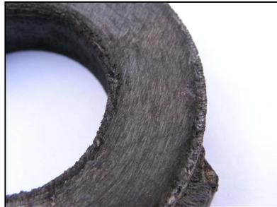
*Figure 75 : Disque mini-BETSI C/C-ZrC - Protocole balayage d'énergies terminé par un RTO – oxydation sur les bords intérieur et extérieur*
