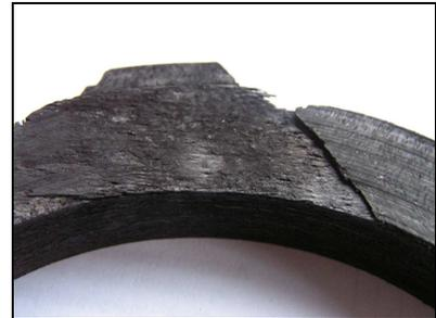
*Figure 76 : Disque BETSI après le protocole balayage d'énergies interrompu – strate décollée en surface*
