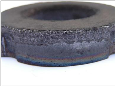
*Figure 74 : Disque mini-BETSI C/C-ZrC - Protocole balayage d'énergies terminé par un RTO – faces latérales blanches et irisées*
