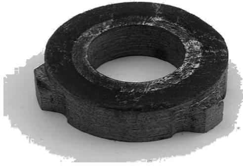
*Figure 81 : Mini-BETSI densifié par du zirconium – Stade I<sub>1</sub> – 80 isofreinages à froid*
