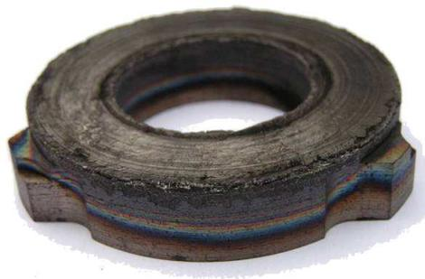
Figure 88 : Mini-BETSI densifié par du zirconium – Stade I<sub>2</sub> – 80 isofreinages à chaud
