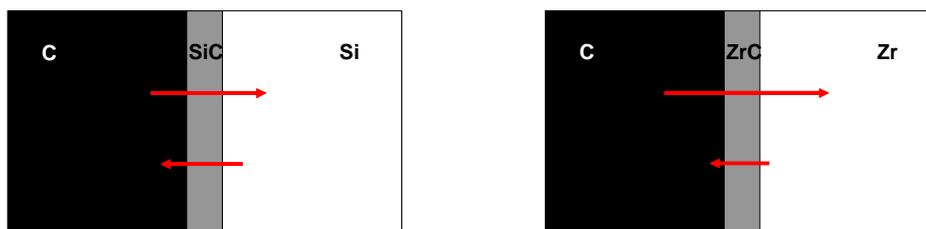
Figure 35 : Schéma de la diffusion du carbone et du métal dans le carbure
