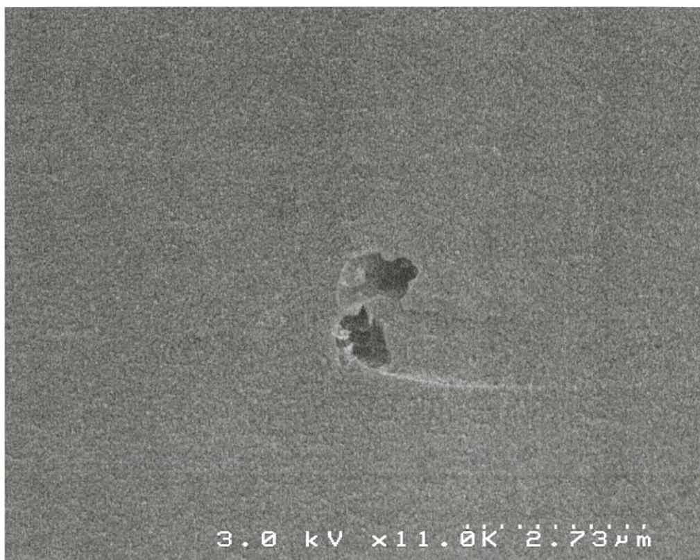
Figure 13 : Porosité interne d'une fibre BN portée à 1500 °C
