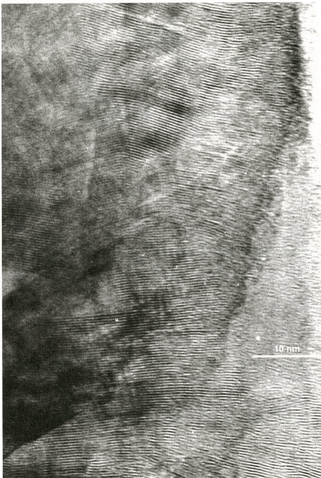
Figure 18 : Cliché en franges de réseau (002) d'une fibre BN portée à 1250 °C
