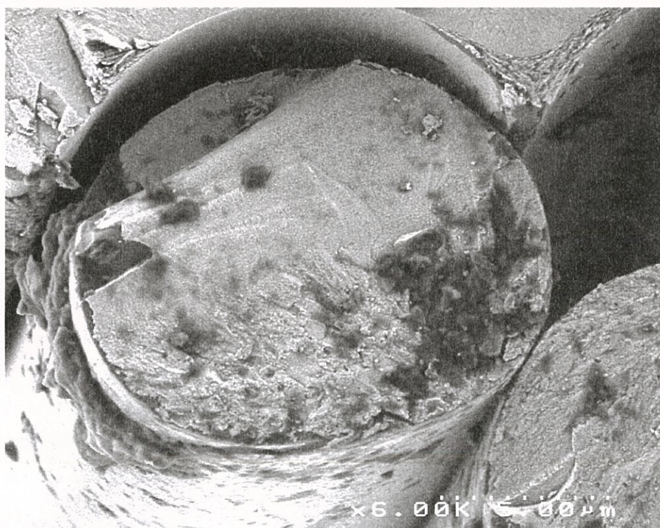
Figure 21 : Cliché MEB montrant la texture de l'interphase issue de la pyrolyse du précurseur poly(borazylène) mésophasique
