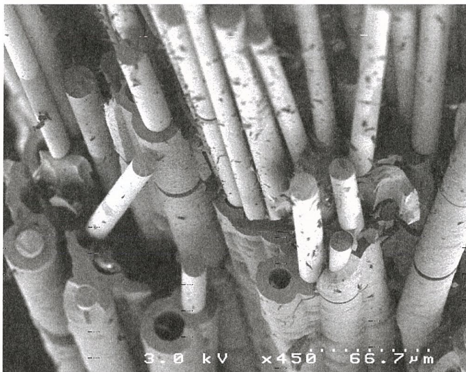
Figure 20 : Cliché MEB du composite modèle 1D Hi-Nicalon/BN/SiC (CVI) montrant le déchaussement des fibres
