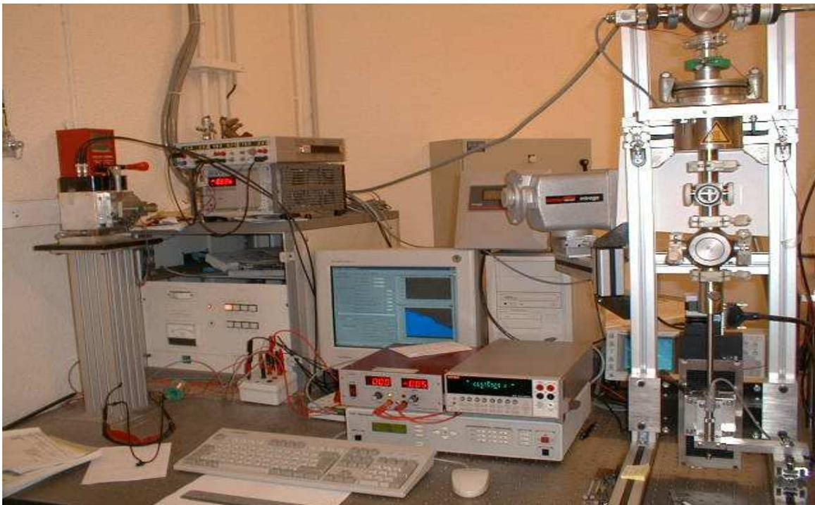
figure 1.9 : Photographie du dispositif de caractérisation thermomécanique.
