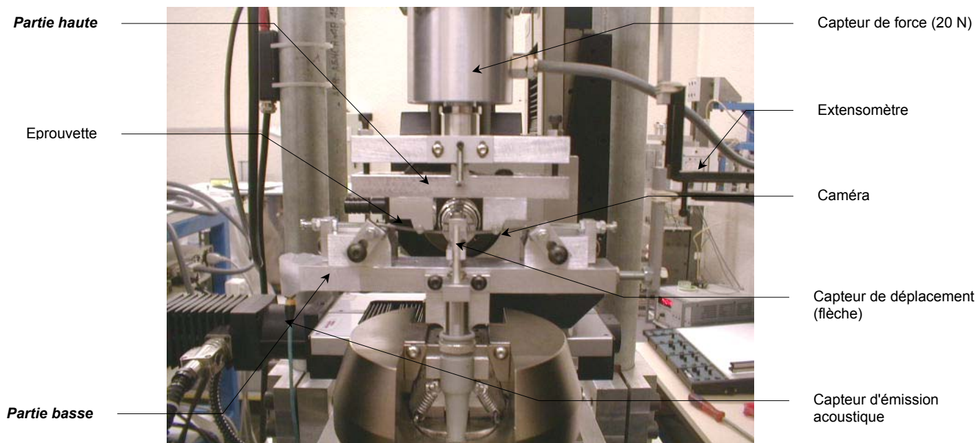
figure 4.16 : photo du montage de flexion 4 points et dispositifs d'acquisition
