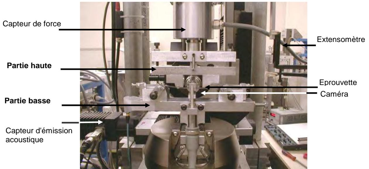
Figure 4.24 - Photographie du montage de flexion.
