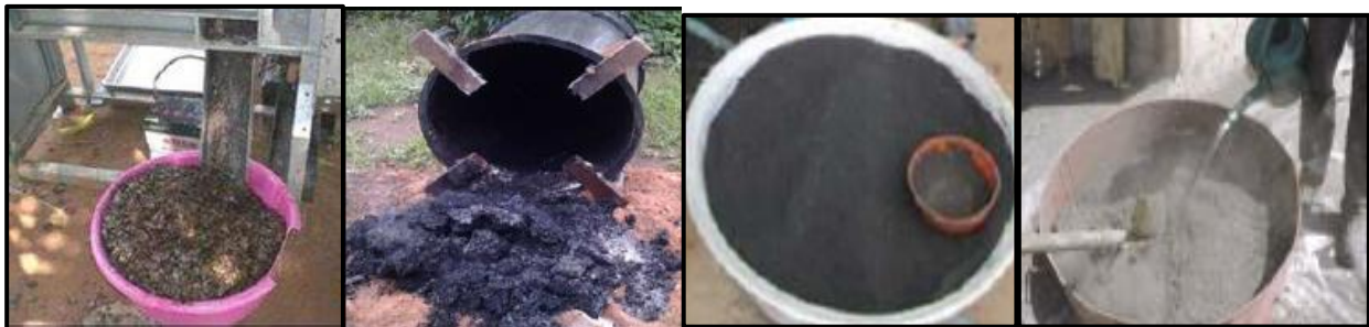
a. Tourteau de coque des noix de cajou, b. Tourteau carbonisé c. Mouture de noix carbonisées, d. Mélange de l'eau avec la mouture carbonisée
