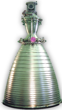
(a) Moteur Vulcain doté d'un col de tuyère en C/SiC (Astrium ST/EADS IW)
