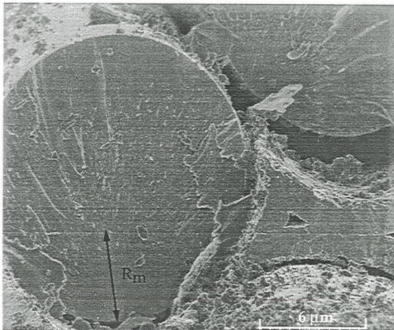
Rupture en fatigue statique à  $850^\circ\text{C}$ , sous 120 MPa (durée de vie = 25 minutes).
