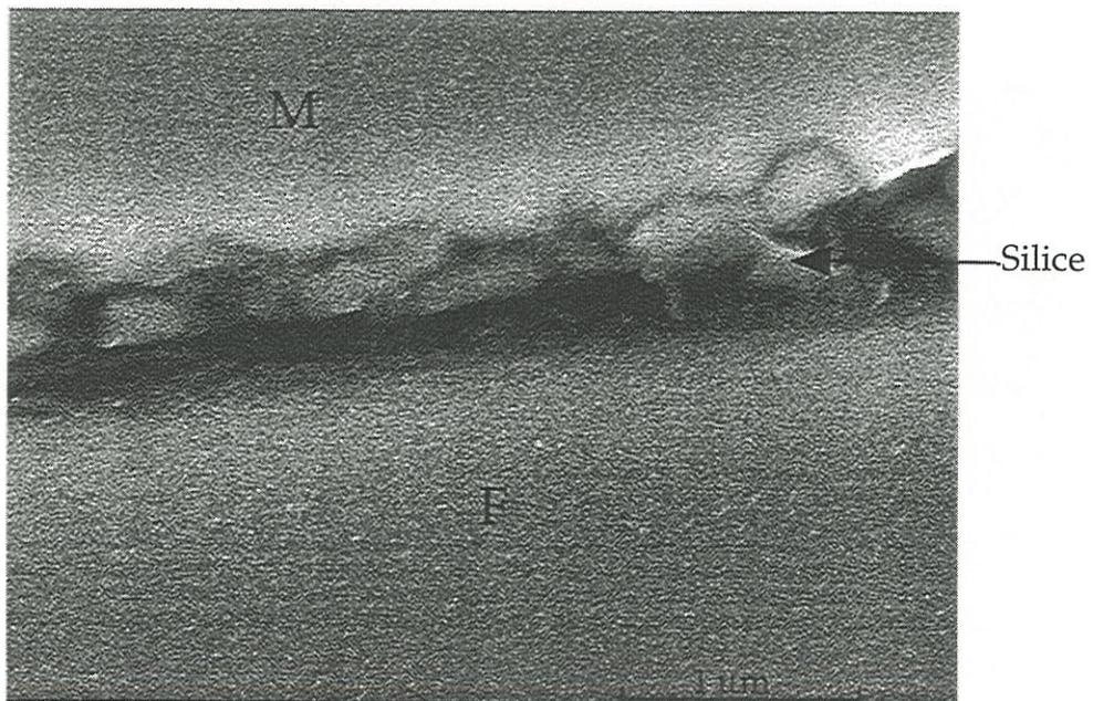
Fig. 3,53 : Micrographie MEB après fatigue statique en traction à 100 MPa à 850°C sous air pendant 48 heures.
