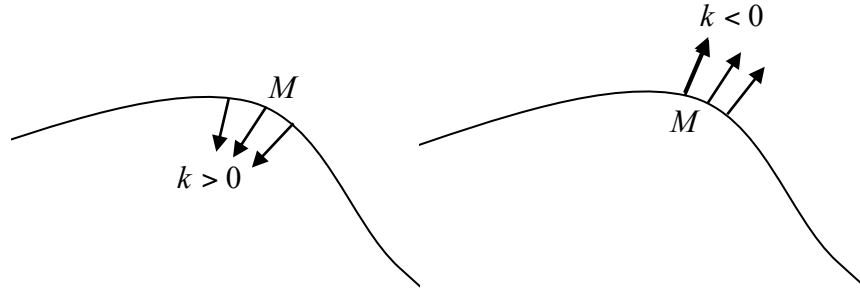
Figure III. 5 : Signe de la courbure en fonction du vecteur d'orientation vers l'axe
