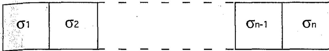
Fig. 1 : Schéma d'une fibre constituée de  $N$  maillons caractérisés par une contrainte à rupture  $\sigma_i$
