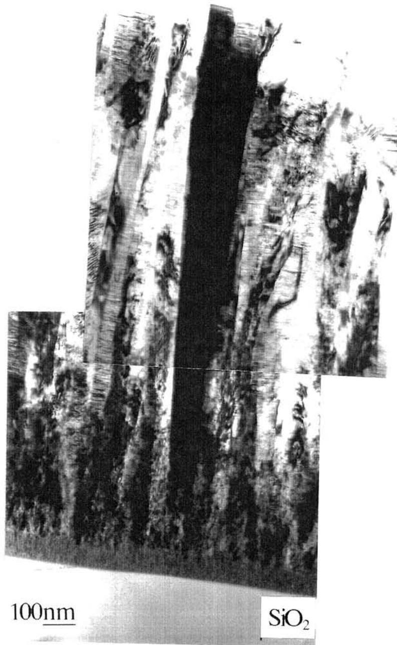
**Fig. 7:** Image MET en champ clair d'un dépôt à base de SiC situé à 2mm de l'entrée d'un pore de 300  $\mu\text{m}$ , après une infiltration de 10 h à  $T = 1100^\circ\text{C}$ ,  $\alpha = 30$  et  $P = 3 \text{ kPa}$ .
