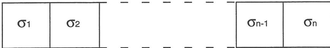
Fig. 1 : Schéma d'une fibre constituée de  $N$  maillons caractérisés par une contrainte à rupture  $\sigma_i$
