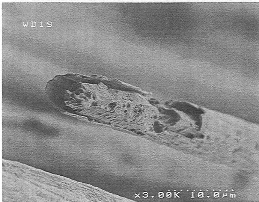
**Figure VII.7 : Oxydation de minicomposites C/C : rôle protecteur du pyrocarbone, les fibres sont oxydées lorsque le pyrocarbone a disparu**
