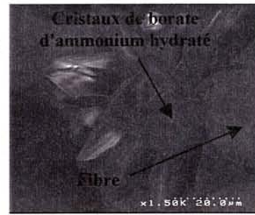
Figure II.3 : Observation par MEB des cristaux de borate d'ammonium en surface des dépôts
