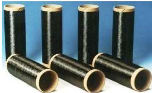
FIGURE 1.4 – *Bobines de fils de 800 fibres SiC Tyranno SA.*
