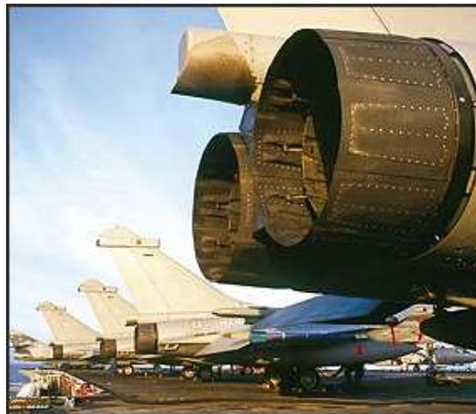
FIGURE 1 – Arrière-corps équipant le Dassault Rafale.
