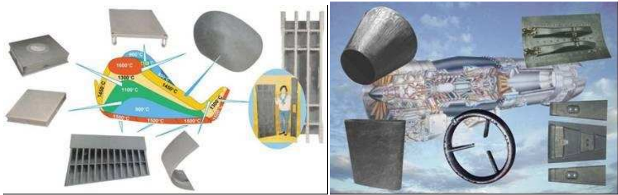
Figure I-2 : composites à matrice SiC pour la navette Hermès (gauche) et pour un moteur d'avion (droite)
