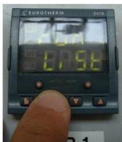
Image 5 : mise en route du programmeur de température des fours
