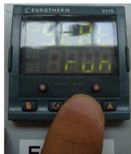
Image 5 : mise en route du programmeur de température des fours
