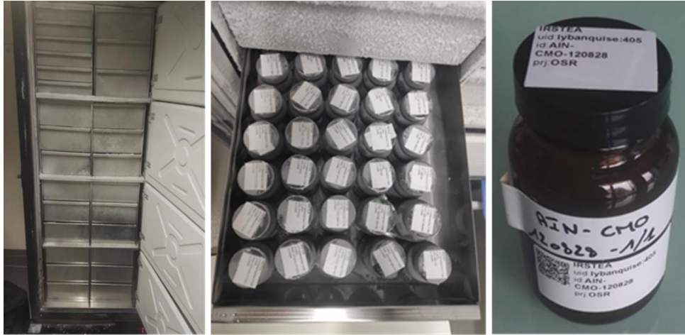
Figure 48 : Enceinte -80°C et flacons contenant les MES/sédiments lyophilisés et bancarisés sous BANQUISE (logiciel COLLEC).
