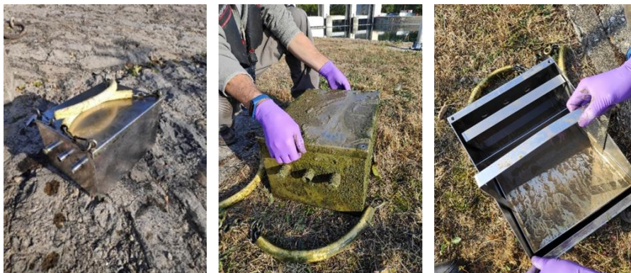
Figure 17 : Photo d'un piège à particules avant et après déploiement dans la rivière (Station de Jons sur le Rhône en période d'étiage – Septembre 2019).
