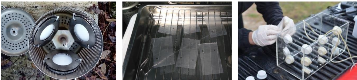
Figure 7 : Photo d'échantillonneurs intégratifs passifs avant déploiement. De gauche à droite : POCIS, SR et DGT.
