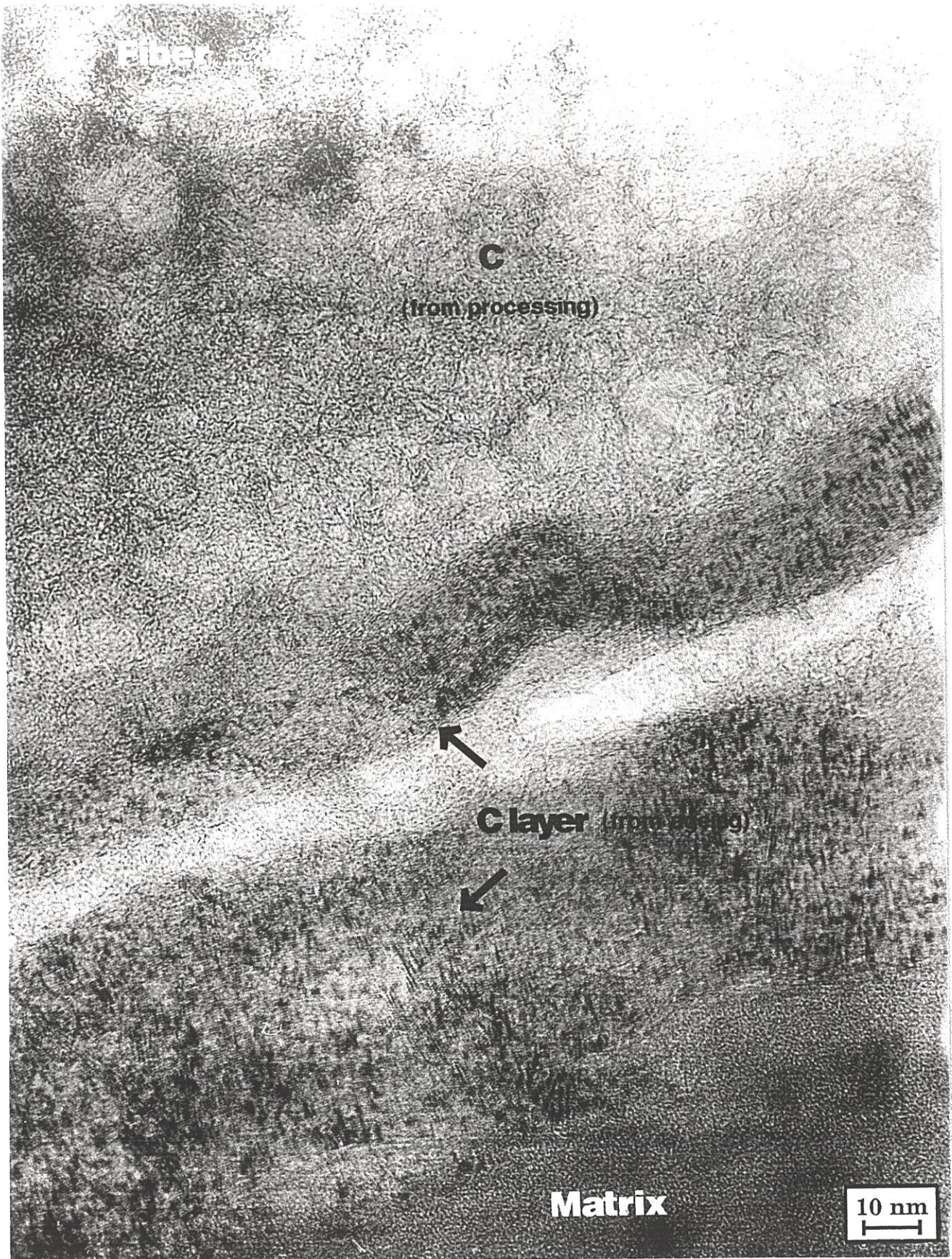
Fig. 20: Image en franges de réseau par MET de la zone interfaciale fibre/matrice dans le composite 0-90° SiC/MAS-L vieilli pendant 96 h à 1100°C sous CO (pression partielle: 100 kPa).
