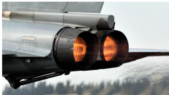
FIGURE 2 – Avion de combat Rafale équipé de ses volets en composite à matrice céramique
