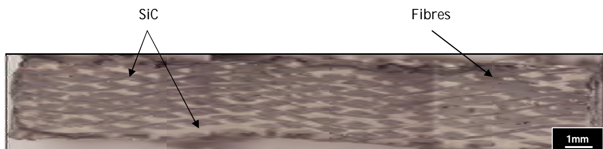
Fig.V.7. Cliché réalisé en loupe binoculaire d'une préforme SiC imprégnée par APS avec une barbotine aqueuse de SiC chargée à 25%vol.
