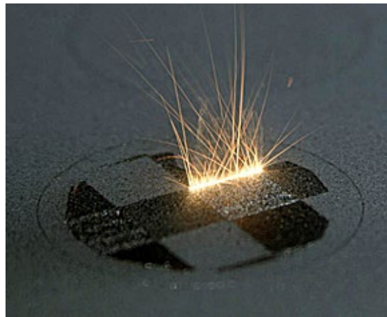
Figure 1-22 Éjections incandescentes caractéristiques du procédé SLM.
