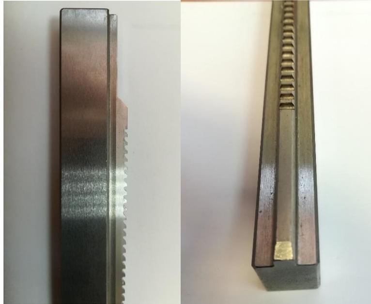
Figure II - 6 : Entailleuse utilisé pour réaliser les entailles des éprouvettes Charpy.
