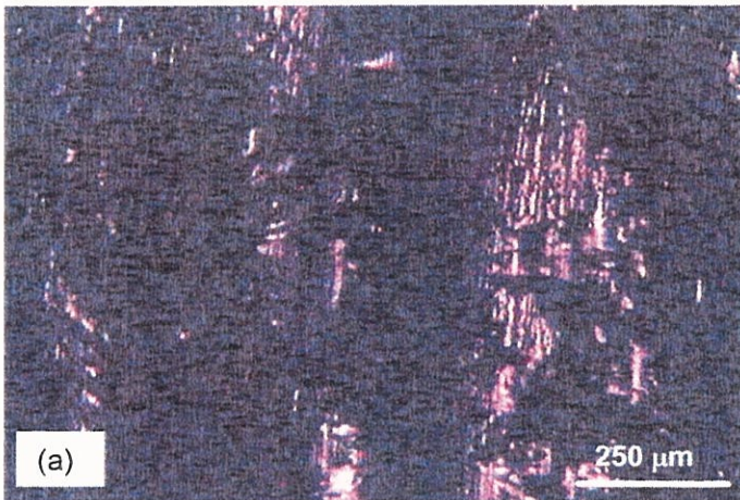
Fig. IV.30: LLPro - sous argon (a) cliché MO en lumière polarisée (b) cliché MEB
