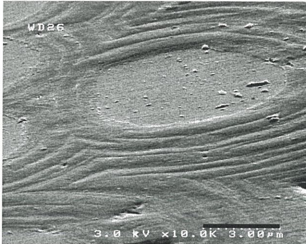
Fig. III.18 : ondulations de la matrice apparaissant au cours du polissage du C/C LRT0 - cliché MEB
