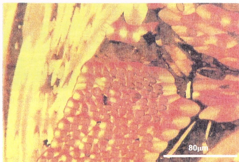
Fig. IV.15 : LLPro - frottement bas (cliché MO en lumière polarisée)
