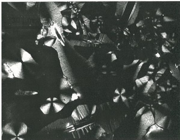
Fig. III.16: \text{Al}_2\text{O}_3/\text{C} à matrice ex-propane cliché MO en lumière polarisée
