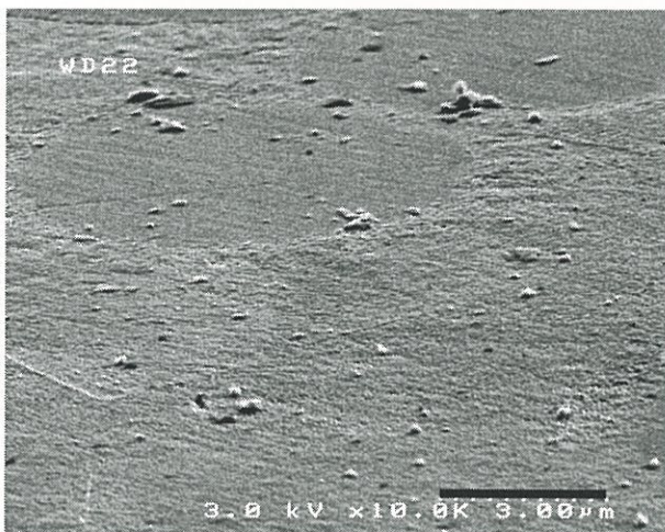
Fig. III.19 : surface polie du C/C LRICVIR cliché MEB
