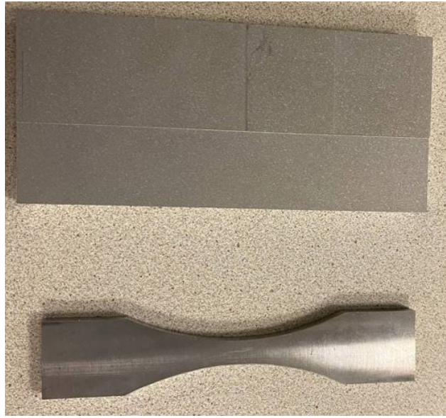
FIGURE III.74 – Échantillons (Al-2024 et Ti6Al4V) traités par grenailage laser
