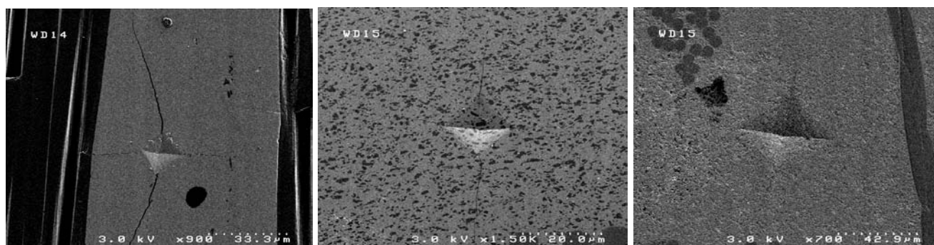
Figure 2-31: Indentation Vickers et formation de fissures au sein de la matrice inter fils pour des composites C f / SiC CVI (Charge de 5 N), C f / SiC-B 4 C (Charge de 5 N) et C f / SiC-BN (Charge de 3 N).
