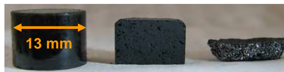
Figure 21 - Pastille brute de M50, pastille graphitée de mélange Luvomaxx + M50, pastille graphitée de M50 (de gauche à droite)
