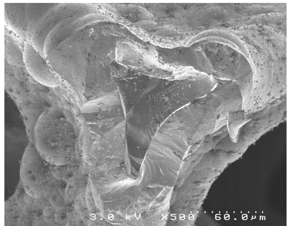
FIGURE 1.14: Clichés au microscope électronique à balayage d'une mousse de carbone vitreux avant et après densification.
