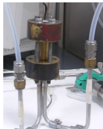
FIGURE 3.51: Montage utilisé pour les mesures de perméabilité.
