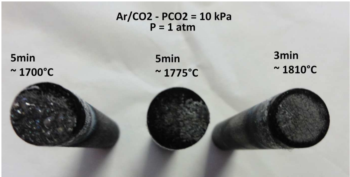
Fig D.4 : Photographie de la surface inférieure des échantillons après traitements sous Ar/CO 2 , P CO 2 = 10 kPa à pression atmosphérique
