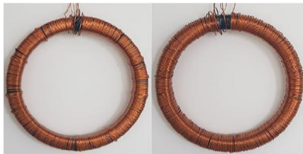
Figure III- 14 - Circuits magnétiques de référence
