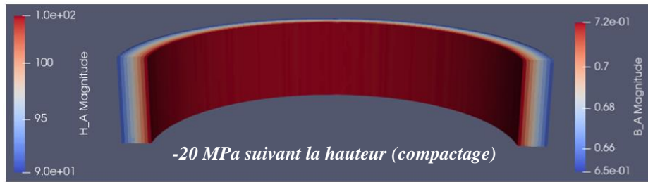
Figure III- 58 - Répartition du champ magnétique (A/m) et de l'induction magnétique (T), sous code_Carmel, sous une contrainte de compression de -20 MPa dans le sens de la hauteur
