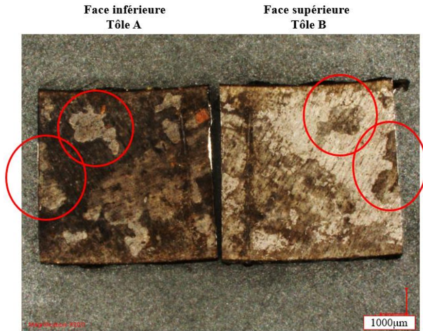
Figure IV- 23 - Image de l'interface entre deux tôles superposées, après séparation de ces dernières, dans le circuit magnétique après imprégnation - Echantillons 2
