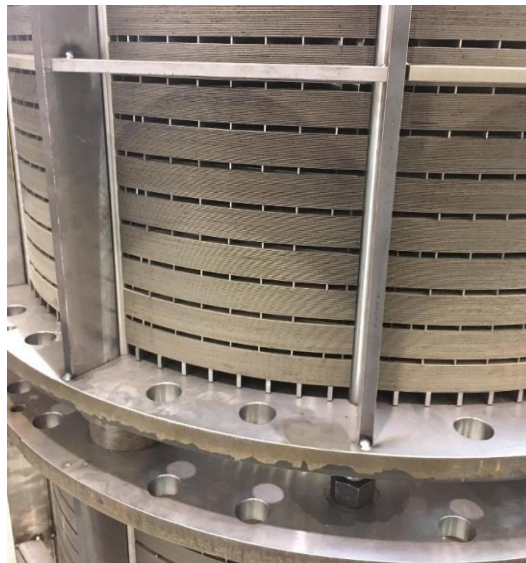
Figure II- 8 - Vue extérieure d'un stator JEUMONT Electric - mise en évidence des intercalaires
