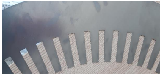
Figure V- 1 - Vue d'une partie d'une tôle statorique JEUMONT Electric
