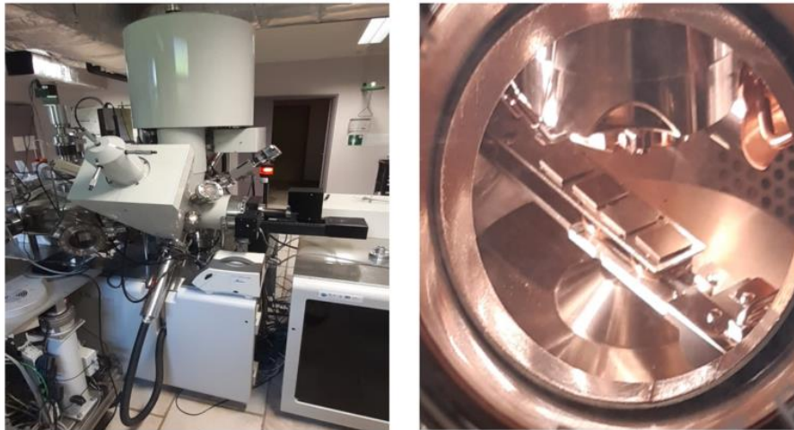
Figure IV- 18 - Vue globale du banc expérimental XPS à gauche et les quatre échantillons placés au sein du banc
