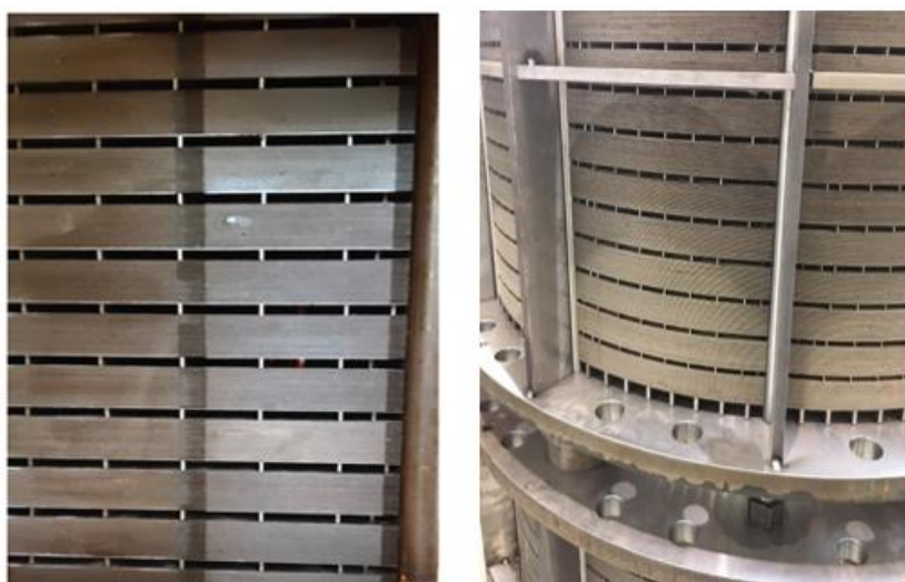
Figure III- 1 - Vue de stators JEUMONT Electric avec présence d’intercalaires
