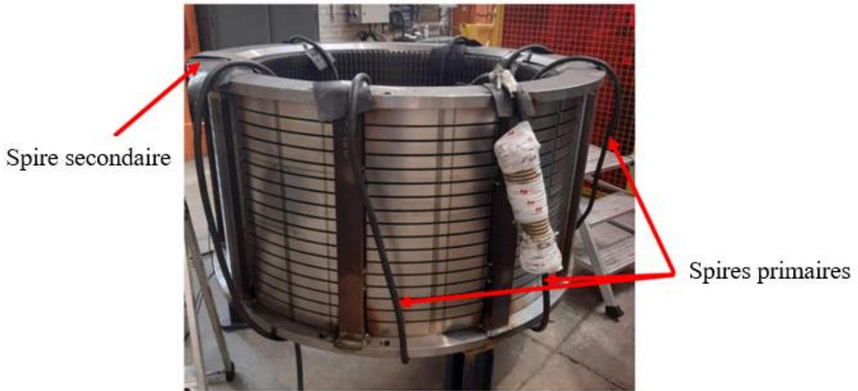
Figure II- 11 - Exemple de stator en essai de magnétisation – N_1 = 7
