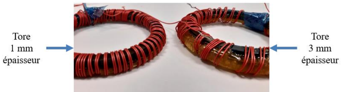
Figure IV- 30 – Tores imprégnés avec les moules d'1 mm et de 3 mm d'épaisseur
