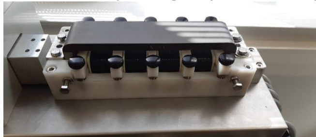
Figure III- 45 - Banc de caractérisation magnétique sous contrainte mécanique de traction ou de compression dans le sens du flux magnétique – Single Sheet Tester
