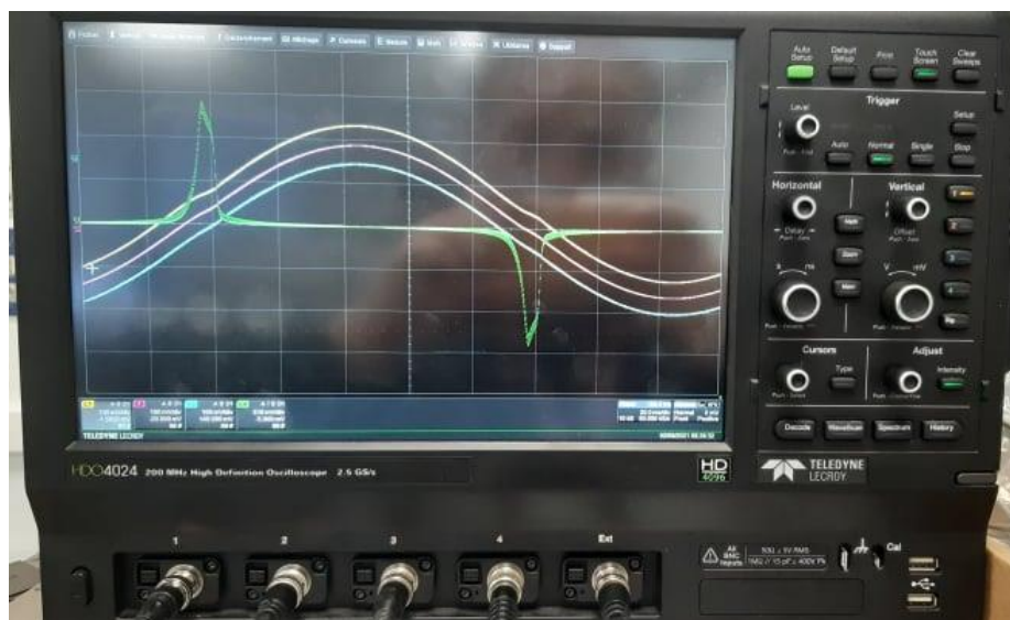
Figure V- 7 - Signaux de sortie du SST miniature à l'oscilloscope – Tension V_2 (vert), tensions de sortie des sondes 1,2 et 3 (respectivement jaune, rose et bleu)
