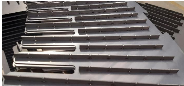
Figure II- 7 - Tôle intercalaire soudée avec intercalaires au niveau des dents et des encoches
