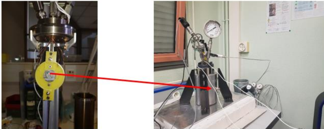
Figure 5-11 Capteur SAW de pression à l'intérieur de l'enceinte de pression
