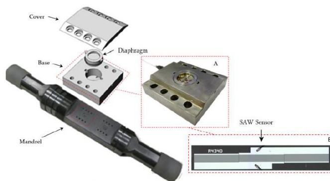
Figure 1-34 Assemblage capteur de pression A: diaphragme monté dans la base. Dans le détail B: vue de dessus du capteur SAW (Sully Quintero et al. 2017)
