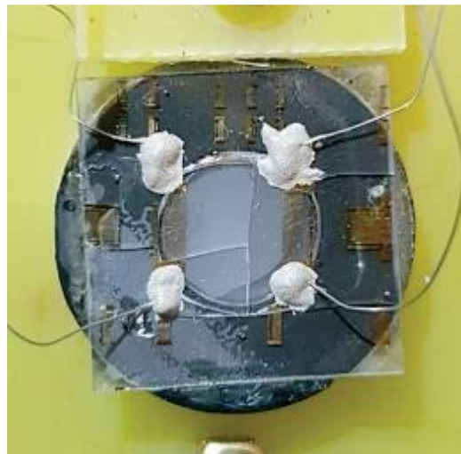
Figure 5-6 Prototype cassé à 15 bars
