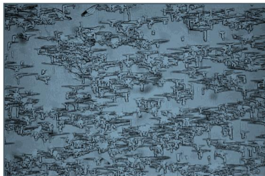
Figure 2-15 Microphotographie d'une surface LN recouverte de précipités de L3N ("Diffusion of Niobium in Congruent Lithium Niobate," n.d.).
