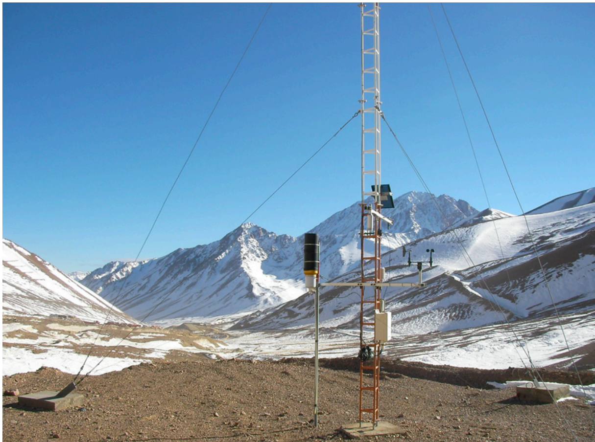
Figure 19 : Station météorologique de La Olla (3976 m) à Pascua-Lama le 21 juillet 2010. Quelle est la représentativité de la hauteur de neige sous le capteur ?
