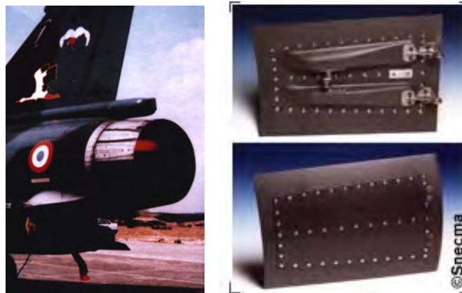
Figure 2 : Exemple d'applications des composites à matrice céramique (CMC) thermostructuraux : dans les volets d'avion
