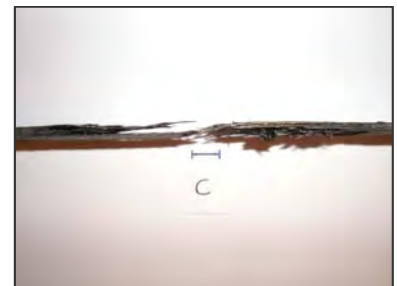
Figure 7 : Faciès de rupture d'une éprouvette du matériau HTA-THT/C-SiC.
