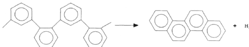
Figure 20 : Mécanisme de pyrolyse selon Trick et Saliba (étape 3). Déshydrogénation de la structure carbonée.
