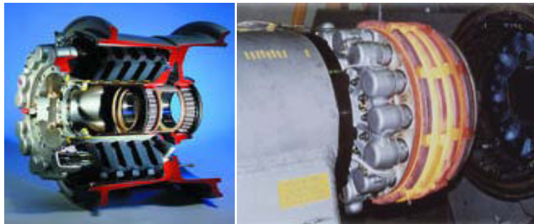
Figure I-1-o : Photographies présentant des disques de frein en composite C/C [M-B. 2008]
