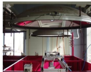
Figure 3.5. Photographie du miroir parabolique au-dessus et support de l'échantillon en dessous.
