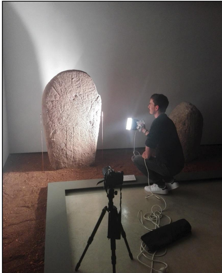
Figure 16 – Évocation du dispositif de Reflectance Transformation Imaging utilisé pour procéder à l’enregistrement des stèles du musée Fenaille à Rodez (photographie : Céline Coste).
