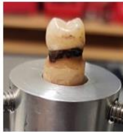
Figure 46 : Mise en place du banc de manipulation avec a) schéma de l'essai en compression b) ajustage de la position de la caméra en fonction de la distance focale c) orientation de la dent au cours du test.
