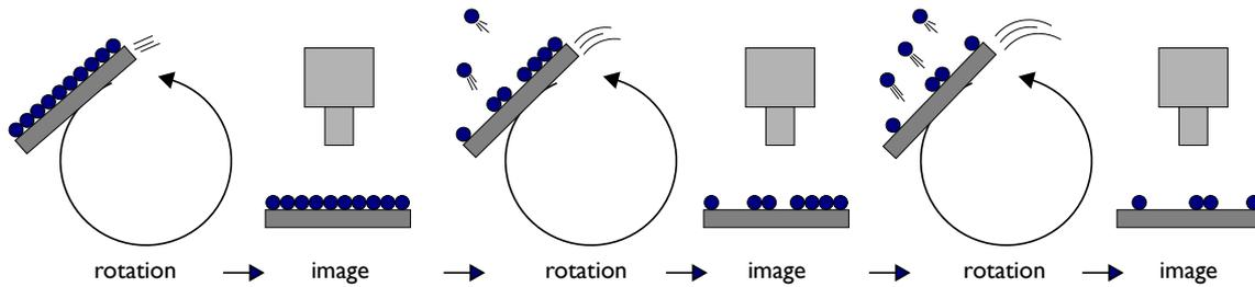
**Figure 4.2** – Méthode de détachement par la force centrifuge. Le substrat est mis en rotation de manière séquentielle à des vitesses de plus en plus élevées. Après chaque séquence de rotation, le nombre de particules restant sur le substrat est déterminé par microscopie.
