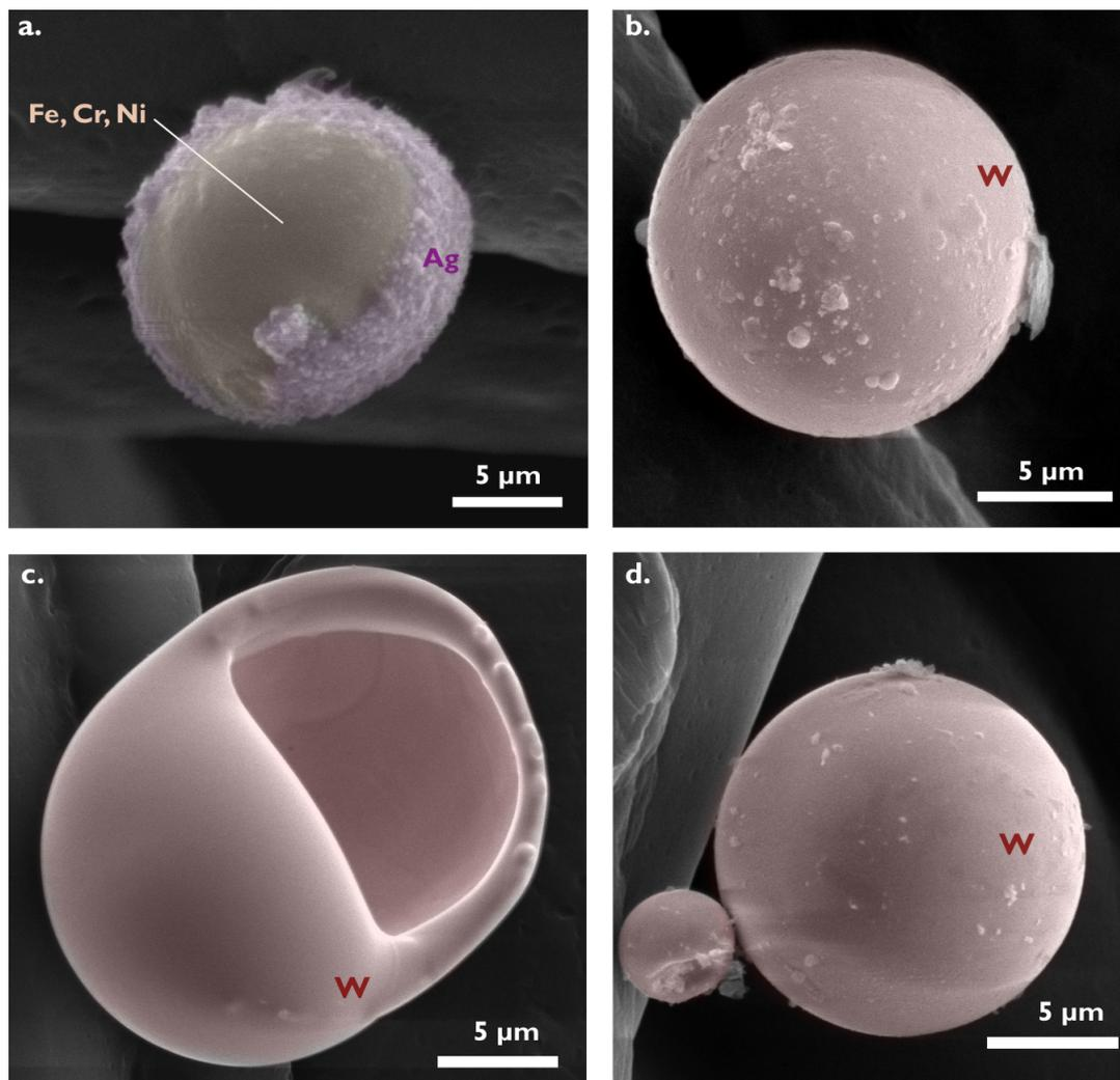
**Figure 3.14** – Micrographies MEB et analyses EDS d’une particule d’acier inoxydable recouverte d’argent (a.) et de particules de tungstène (b. - d.) collectées avec la Duster Box dans le tokamak WEST.
