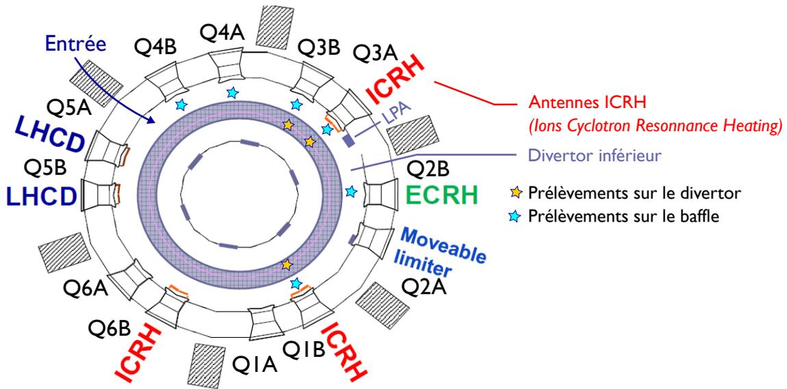
**Figure 3.11** – Vue de dessus de la chambre à vide de WEST avec les principaux secteurs et composants installés dans la machine. Les prélèvements réalisés sont repérés par les étoiles de couleurs. (Crédits CEA/IRFM)
