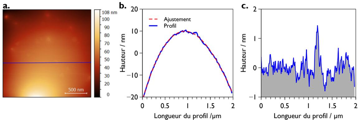
**Figure 4.21** – a. Topographie du sommet de la particule de 10.5  $\mu\text{m}$  de rayon. b. Profil effectué sur le sommet de la particule de tungstène (ligne bleue) et ajustement parabolique (ligne rouge). c. Rugosité du sommet de la particule après soustraction de l'ajustement parabolique.
