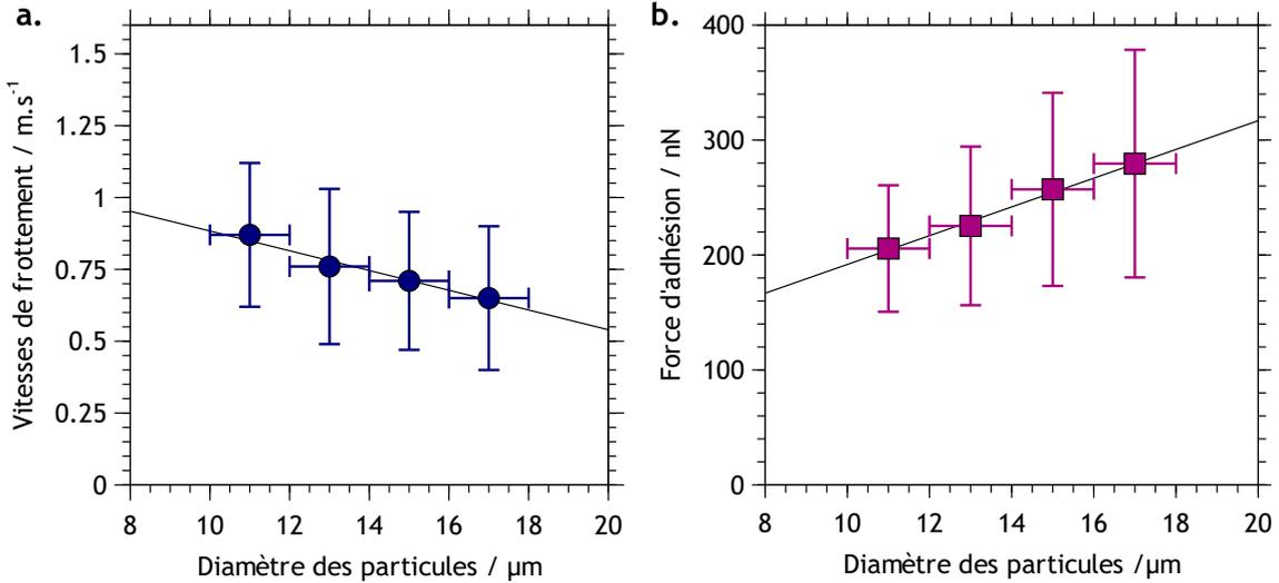
**Figure 6.9** – a. Vitesses de frottement seuils obtenues pour le détachement de 50 % des particules de tungstène en fonction de leur taille. b. Forces d'adhésion correspondantes calculées avec le modèle d'Ibrahim et al. (2003).
