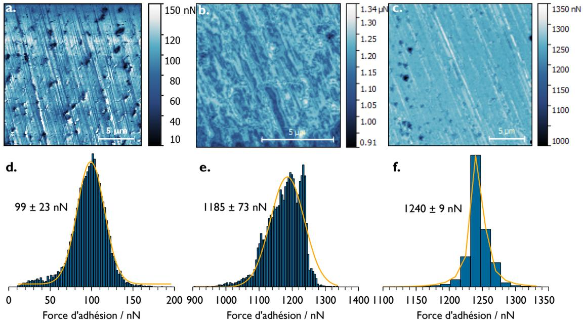
**Figure 4.11** – Exemples de distributions de forces d’adhésion obtenues avec le substrat en tungstène poli miroir et une particule de : 1  $\mu\text{m}$  de rayon (a. et d.) et 5  $\mu\text{m}$  de rayon (b., e. et c., f.)
