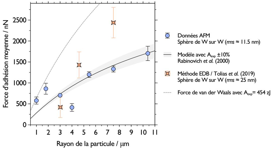
**Figure 4.24** – Forces d'adhésion moyenne en fonction du rayon des particules de tungstène pour une surface de tungstène poli miroir. Le modèle de Rabinovich est représenté avec une variation de 10 % sur la constante de Hamaker  $A_{\text{exp}}$  trouvée expérimentalement au paragraphe précédent.
