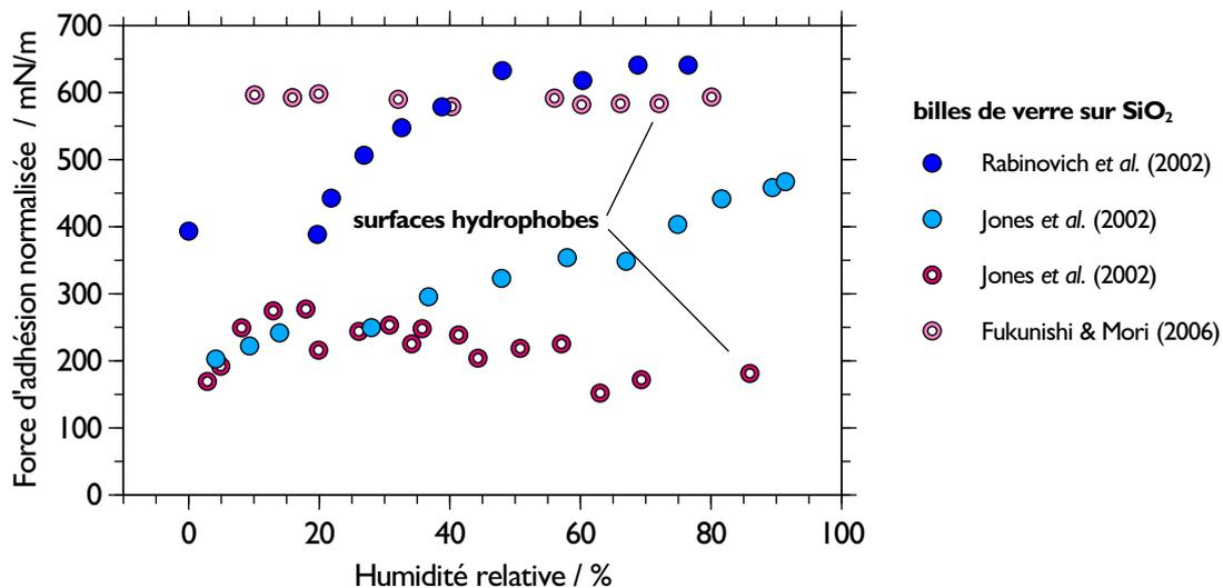
Figure 2.14 – Évolution des forces capillaires normalisées en fonction de l'humidité relative mesurées par AFM dans plusieurs études pour des billes de verre sur du SiO<sub>2</sub>.
