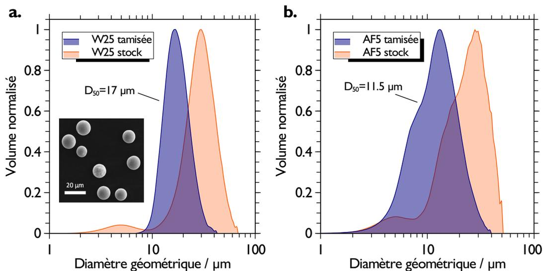
**Figure 3.15** – Distributions granulométriques en volume de la poudre Tekna W25 (a) et AF5 (b) avant/après tamisage. Insert a : image MEB des particules de tungstène sphériques constituant la poudre W25 après tamisage.
