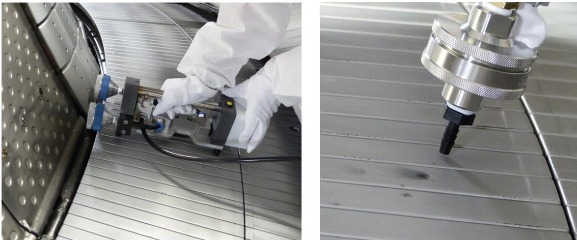
**Figure 3.12** – Photographies des systèmes de prélèvement de poussières utilisés dans WEST. À gauche la Duster Box sur une aiguille du divertor, à droite le système d'aspiration avec le porte filtre. (Crédits photo CEA/IRFM)
