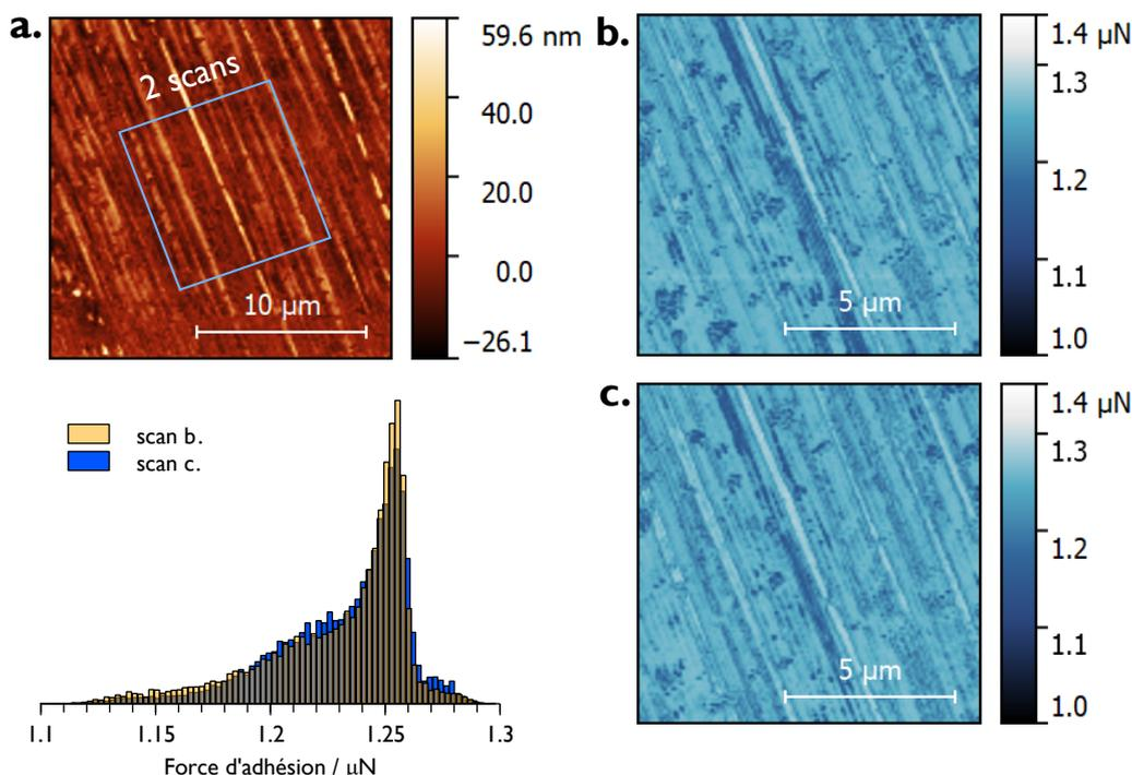
**Figure 4.12** – a. Topographie AFM de  $20 \mu\text{m}$  de large montrant la zone où les deux cartographies d'adhésion (b. et c.) ont été effectués. Le diagramme présente les deux distributions des forces d'adhésion extraites de chacune des cartographies.
