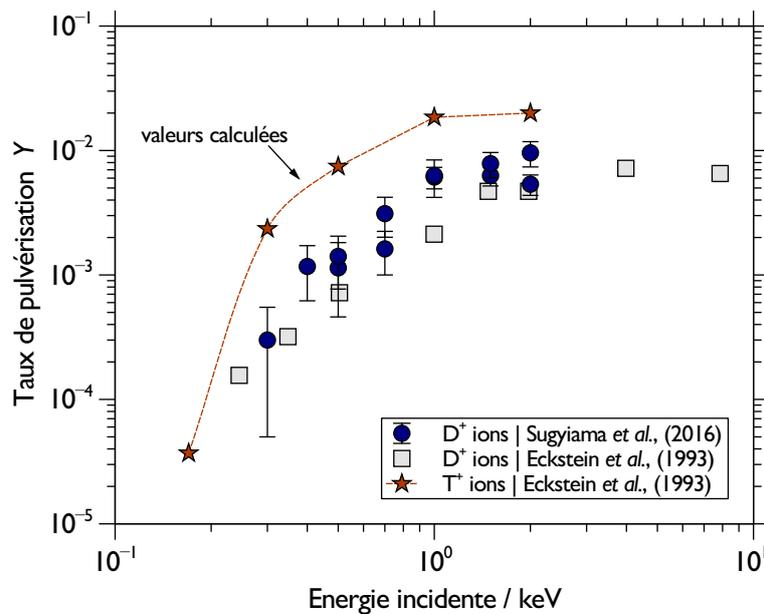
**Figure 1.8** – Taux de pulvérisation du tungstène en fonction de l'énergie incidente d'ions de deutérium (Sugiyama et al., 2016) ou de tritium à incidence normale. Les taux de pulvérisation donnés pour les ions tritium sont issus de calculs analytiques par Eckstein et al. (1993).
