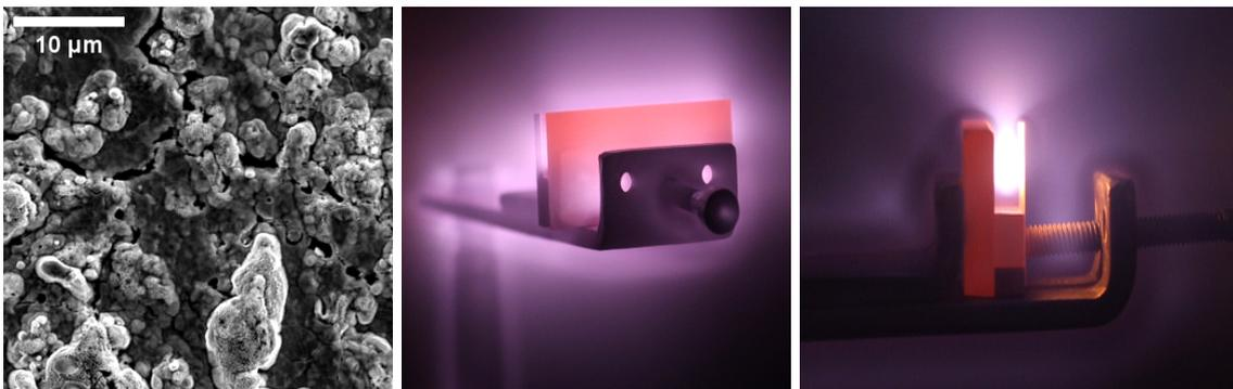
**Figure 3.17** – (à gauche) Micrographie MEB de la surface de tungstène exposée à un plasma d'hélium. (au centre et à droite) Photographies du procédé d'érosion par plasma d'hélium. Crédits (Stancu et al., 2017).
