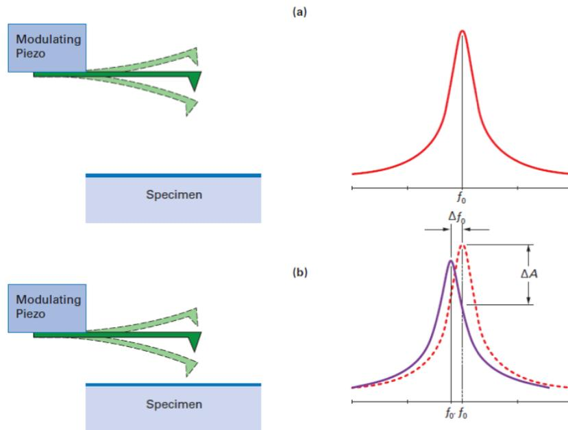
**Figure 3** – Courbes de résonances d'un levier AFM en mode *Tapping* loin de la surface (a) et à proximité de la surface (b). Lorsque le levier est proche de la surface, la résonance se décale vers des fréquences plus basses et l'amplitude diminue (Bruker, 2017).
