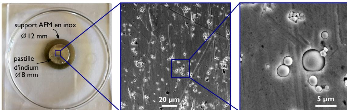
**Figure 5.7** – Exemple d'une pastille d'indium fixée sur un porte échantillon d'AFM en inox. Les micrographies MEB montrent que les particules de tungstène sont réparties de manière homogène dans la pastille d'indium.
