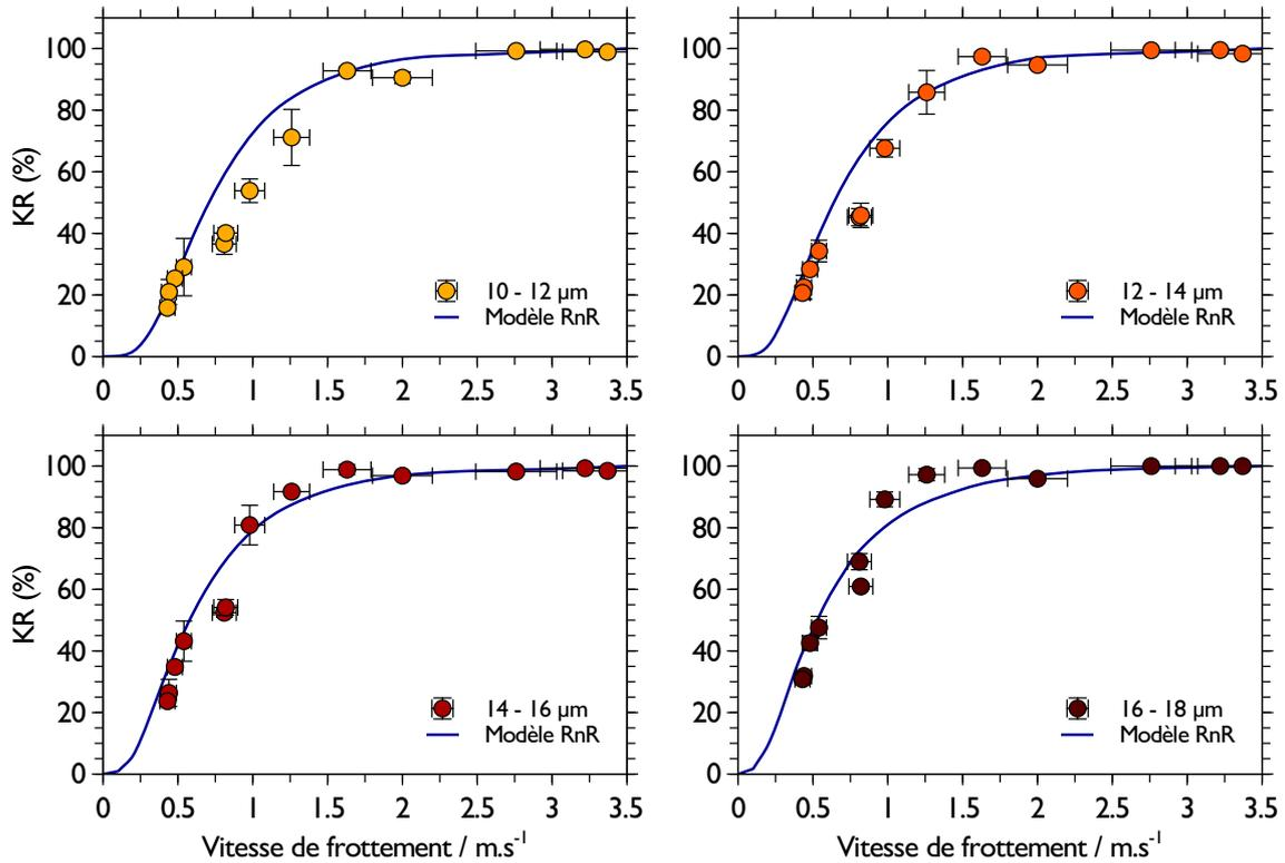
**Figure 6.7** – Fractions de mise en suspension en fonction de la vitesse de frottement pour les particules de tungstène W25 neutres. Comparaison avec le modèle de [Reeks and Hall \(2001\)](#) pour une énergie surfacique d'adhésion  $\Delta\gamma = 0.41 \text{ J m}^{-2}$ .
