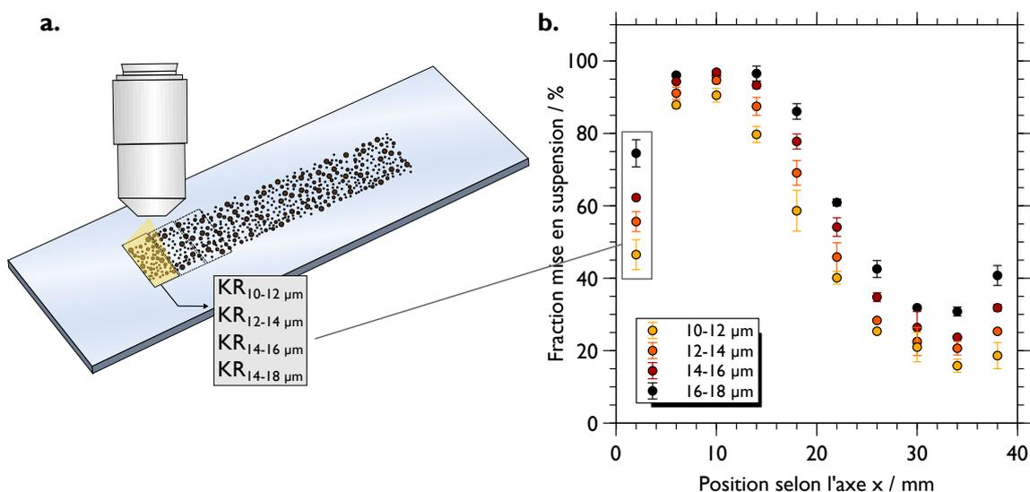
**Figure 6.4** – a. Schéma de la procédure de comptage avec le microscope sur les dix segments de  $4 \times 12 \text{ mm}^2$  le long du dépôt. b. Fractions mise en suspension obtenue pour quatre classes de tailles avec la poudre W25 pour un débit d'air de  $70 \text{ L min}^{-1}$  dans la Duster Box.
