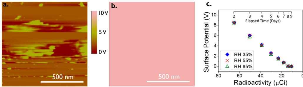
**Figure 2.23** – a. Potentiel de surface pour un échantillon d'or activé à 32  $\mu\text{Ci}$ . b. Potentiel de surface pour un échantillon d'or activé à 108  $\mu\text{Ci}$ . Pour cet échantillon, les valeurs du potentiel de surface sont supérieures à 10 V, la limite de saturation de l'instrument KPFM. c. Influence de la radioactivité sur le potentiel de surface pour différentes humidité relative. (Kweon et al., 2013).
