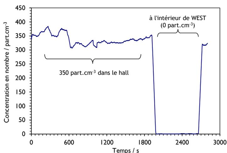
**Figure 3.10** – Nombre de particules par cm<sup>3</sup> prélevées par le compteur optique dans le hall de WEST et à l'intérieur du tore juste après la remontée en pression dans la chambre à vide.
