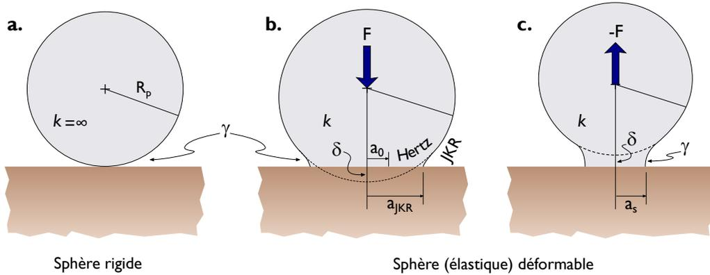
**Figure 2.4** – Représentation des géométries de Hertz et JKR pour une sphère rigide sur une surface rigide (a.), une sphère déformable sur une surface rigide (b.) avec un stress mécanique en compression ( $F$ ) en absence (Hertz) ou en présence des phénomènes d'adhésion (JKR) ; ou en tension ( $-F$ ) dans le cas où la sphère est sur le point de rompre le contact avec la surface solide (c.).
