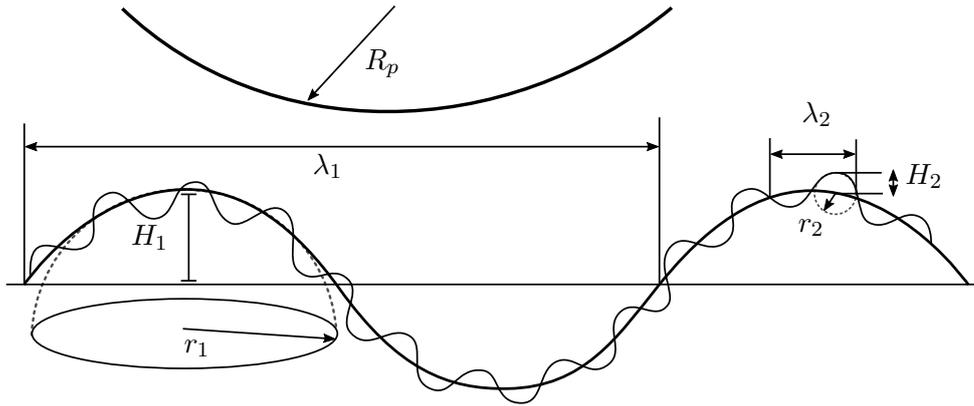
Figure 2.9 – Illustration de la géométrie proposée par Rabinovich et al. (2000b) Pour une surface composée de deux échelles de rugosité.
