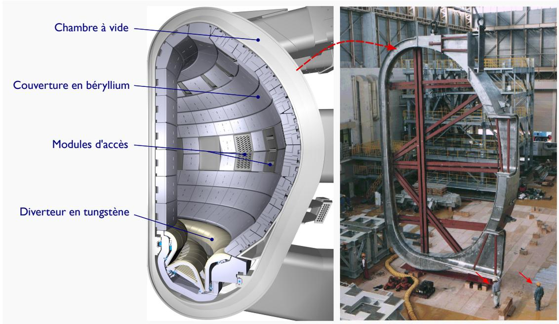
**Figure 1.5** – Schéma de la chambre à vide d'ITER avec ses différents composants (source [www.iter.org](http://www.iter.org)). Photographie d'une maquette à l'échelle 1 d'un secteur de la chambre à vide par Nakahira et al. (1999).
