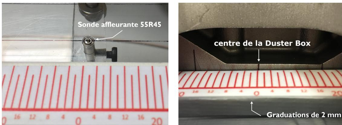
**Figure 3.3** – (photo de gauche) La sonde 55R45 est affleurante à la surface au centre de la plateforme. La règle rouge a des graduations de 2 mm et l'origine  $x = 0$  est prise au niveau de la sonde. (photo de droite) La Duster Box est placée contre la règle et l'entrée d'air, le centre et la sortie d'air du canal sont marqués sur le côté de l'appareil.
