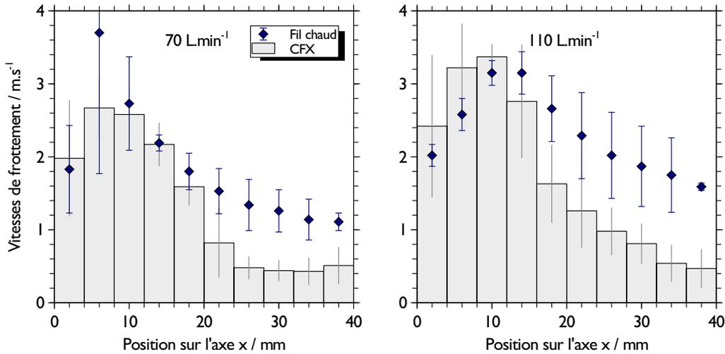
**Figure 3.7** – Comparaison entre les vitesses de frottement obtenues numériquement avec *Ansys CFX* et les mesures expérimentales (moyenne des 3 positions sur l'axe y) obtenues avec l'anémométrie à fil chaud.
