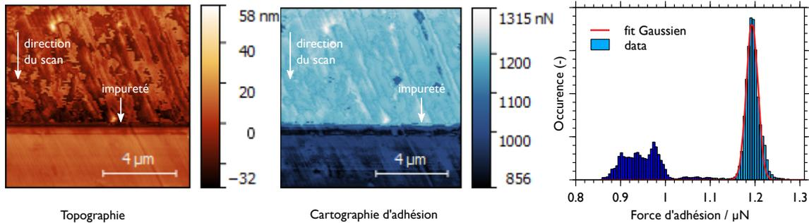
**Figure 4.13** – Exemple montrant une impureté collectée par la pointe au cours d'un scan en mode PF-QNM. Arrivé au 2/3 de l'image, on constate un saut marqué sur les images de topographie (à gauche) et d'adhésion (au centre). Une diminution d'environ 300 nN sur les forces d'adhésion est clairement visible sur l'histogramme (à droite).
