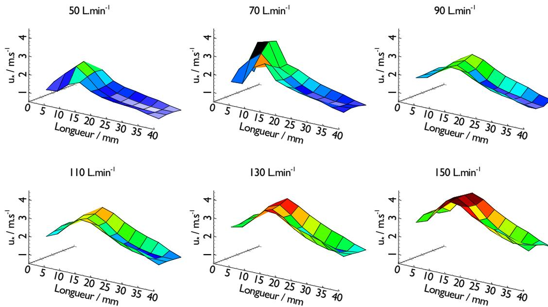
**Figure 3.6** – Cartographies 3D des mesures de vitesses de frottement dans la Duster Box effectuées avec l’anémométrie à fil chaud pour les 6 débits d’air testés.
