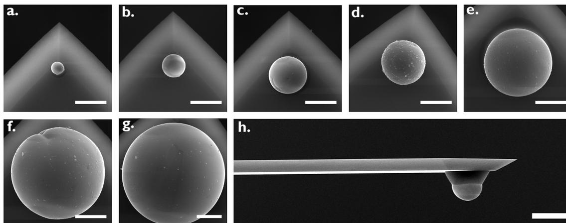
**Figure 4.9** – Micrographies MEB des particules de tungstène sphériques greffées sur les leviers AFM. Les rayons des particules sont : a. 1  $\mu\text{m}$ , b. 1.8  $\mu\text{m}$ , c. 3  $\mu\text{m}$ , d. 3.9  $\mu\text{m}$ , e. 5.5  $\mu\text{m}$ , f. 7.5  $\mu\text{m}$  et g. 10.5  $\mu\text{m}$ . L'image h. présente une vue de côté du levier d. avec la particule de 3.9  $\mu\text{m}$  de rayon. Les échelles sont toutes égales à 10  $\mu\text{m}$ .
