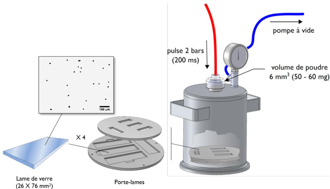
**Figure 6.3** – Représentation du porte-lames et du masque permettant le dépôt des particules sur des zones définies et sur quatre lames de verre en même temps. L'image de microscopie optique montre des particules individuelles bien séparées les unes des autres sur la lame de verre.
