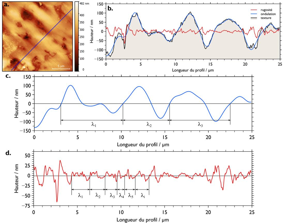
**Figure 4.6** – Exemple de la procédure utilisée pour extraire les paramètres de rugosité de la surface de tungstène de rugosité intermédiaire. **a.** Topographie AFM de la surface avec le profil extrait représenté par la ligne bleue. **b.** Analyse du profil avec Gwyddion pour extraire les deux échelles d'ondulation et de rugosité. **c.** Ondulation le long du profil. **d.** Rugosité le long du profil.
