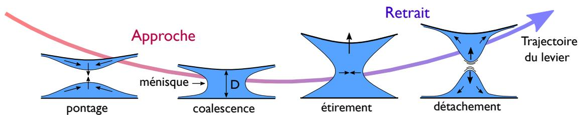
**Figure 4.17** – Séquences d'approche/retrait du levier AFM en cas d'humidité relative élevée pour des matériaux hydrophiles. Si une pellicule d'eau est adsorbée sur la surface, un pont capillaire se forme. Le ménisque créé entre la particule et la surface s'étire à mesure que le levier se retire jusqu'au détachement.
