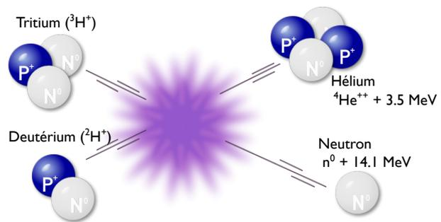
**Figure 1.2** – Schéma de la réaction de fusion entre un atome de tritium et un atome de deutérium.
