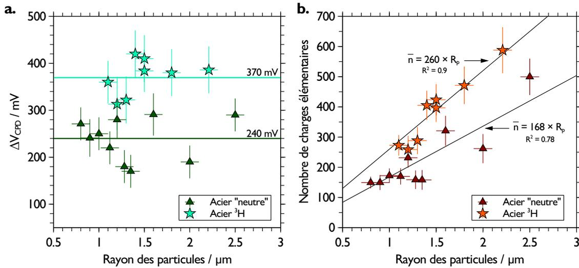
**Figure 5.18** – a. Différences de potentiel mesurées par KPFM sur des particules d’acier tritiées et ”neutres” en fonction de la taille des particules. b. Nombre de charges élémentaires calculé avec la relation 5.12 pour les particules tritiées et ”neutres” en fonction de la taille des particules.
