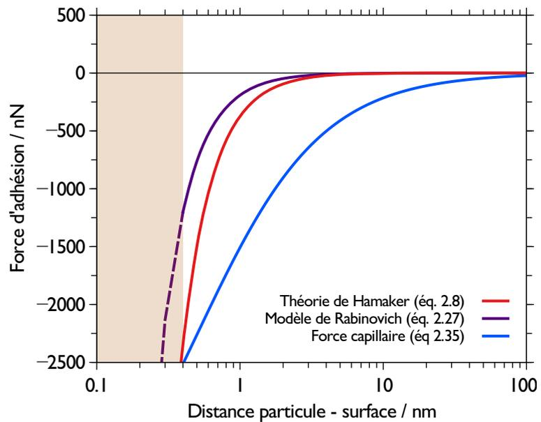
**Figure 2.17** – Évolution des forces capillaires et des forces de van der Waals en fonction de la distance entre une particule de tungstène de 5  $\mu\text{m}$  de rayon et une surface rugueuse. L'humidité relative est ici fixée à 40 %.
