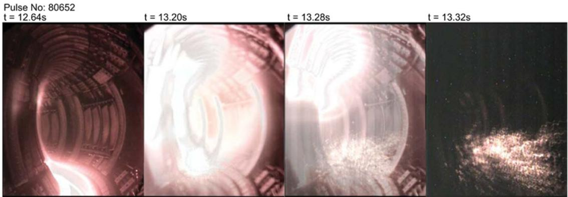
**Figure 1.6** – Images de la caméra CCD couleur COHU JET (KL1) durant le tir 80652. Le plasma se termine par une disruption qui induit des forces de 0.43 MN sur la structure de la chambre à vide. Un nuage de débris est observé à  $t = 13,20$  s et dans les images suivantes. Sur les deux images à  $t = 13,28$  s et  $t = 13,32$  s, on distingue nettement le tremblement de la caméra dû au choc éprouvé par la structure durant la disruption (Flanagan et al., 2015).
