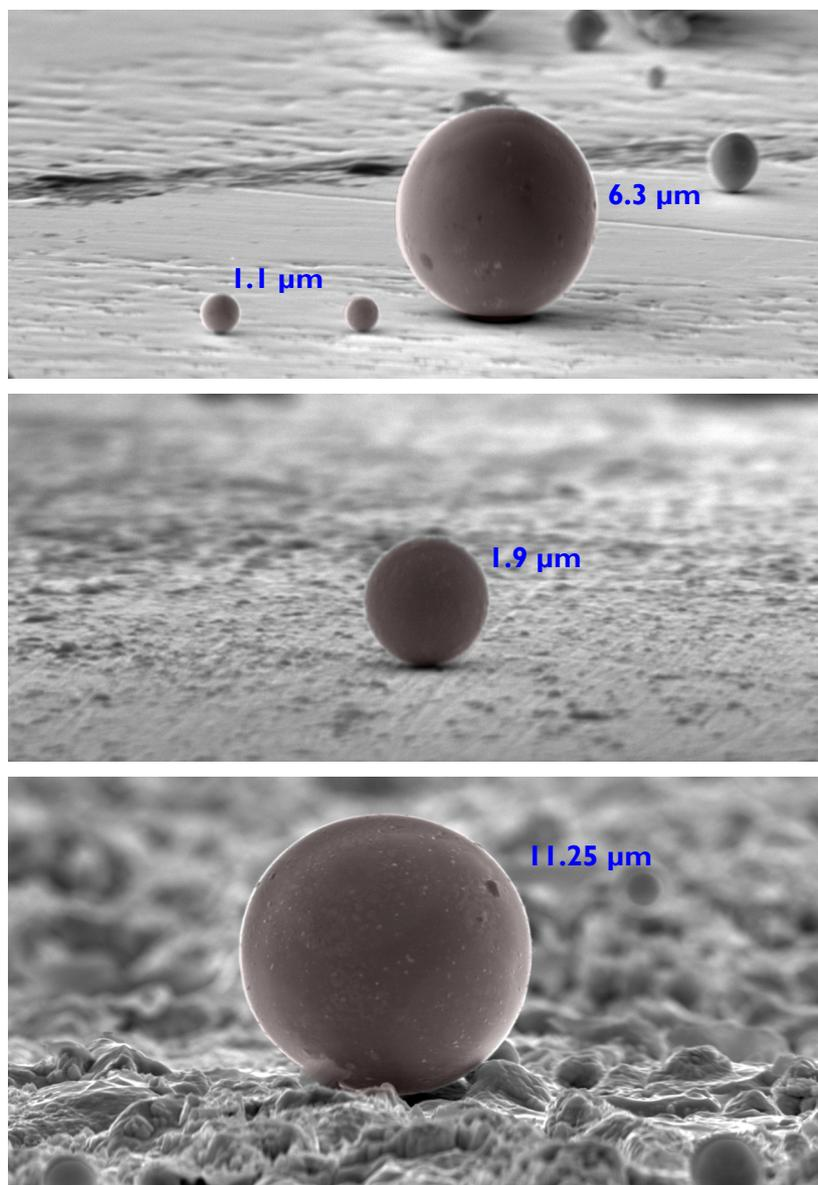
**Figure 4.1** – Micrographies MEB avec un angle de 85° de particules de tungstène déposées sur des surfaces en tungstène polie miroir (haut), de rugosité intermédiaire (centre) et rugueuse (bas).
