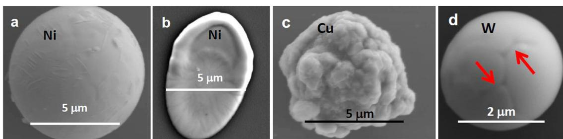
**Figure 1.11** – Images MEB de particules métalliques collectées par Rubel et al. (2018) : a et b gouttelettes et éclaboussures de nickel (Inconel) ; c une particule de cuivre et d une particule sphérique de tungstène probablement formée par l'agglomération de *flakes* issus du revêtement en W des tuiles de graphites.
