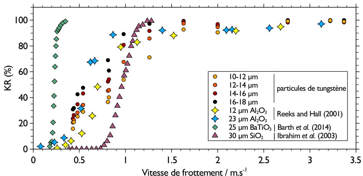
**Figure 6.6** – Fractions de mise en suspension en fonction de la vitesse de frottement pour les particules de tungstène W25, des particules d'alumine (Reeks and Hall, 2001), de titanate de baryum (Barth et al., 2014) et de verre (Ibrahim et al., 2003).
