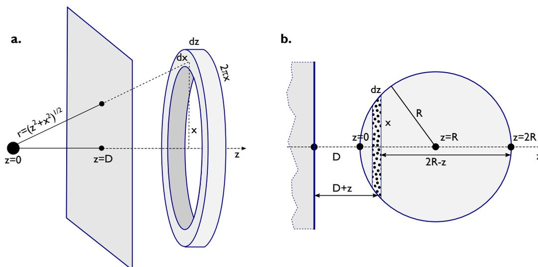
**Figure 2.3** – Méthode de sommation des énergies d'interaction entre des molécules constituant des solides macroscopiques. **a.** pour une molécule à proximité d'une surface et **b.** pour une particule sphérique à proximité d'une paroi ( $R_p \gg D$ ).
