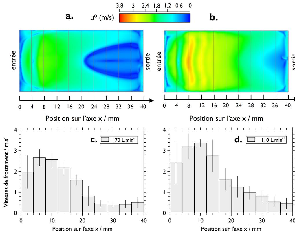
**Figure 3.2** – Cartographies 2D obtenues avec *Ansys CFX* pour un débit d’air dans la Duster Box de  $70 \text{ L}\cdot\text{min}^{-1}$  (a.) et  $110 \text{ L}\cdot\text{min}^{-1}$  (b.). Histogrammes présentant la valeur moyenne et l’écart-type des vitesses de frottement calculées dans chaque segment du canal de la Duster Box pour les deux débits de  $70 \text{ L}\cdot\text{min}^{-1}$  (c.) et  $110 \text{ L}\cdot\text{min}^{-1}$  (d.).
