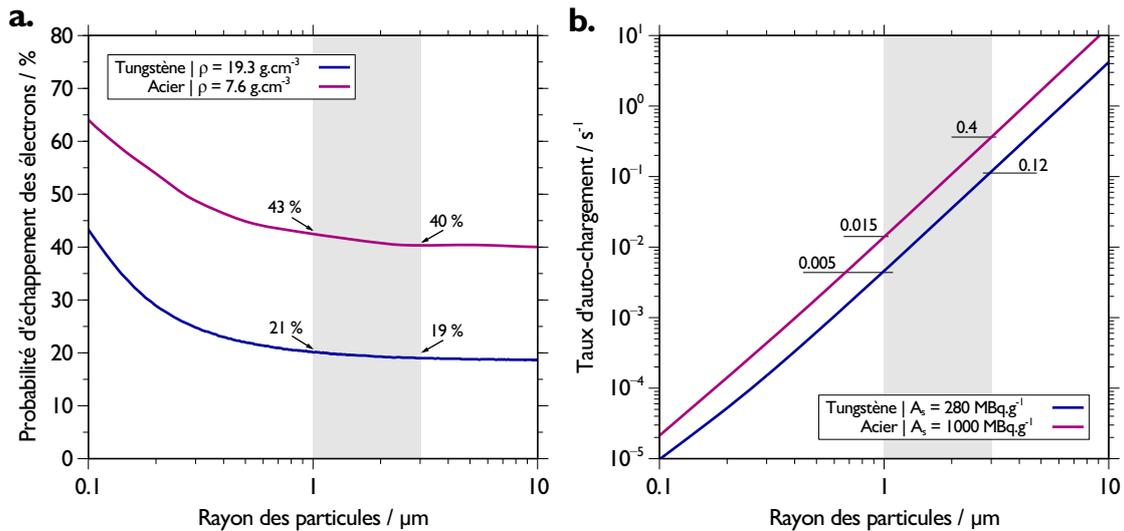
**Figure 5.19** – a. Probabilités d'échappement des électrons en fonction du rayon des particules de tungstène ou d'acier. b. Taux d'auto-chargement pour les deux matériaux en fonction du rayon des particules.
