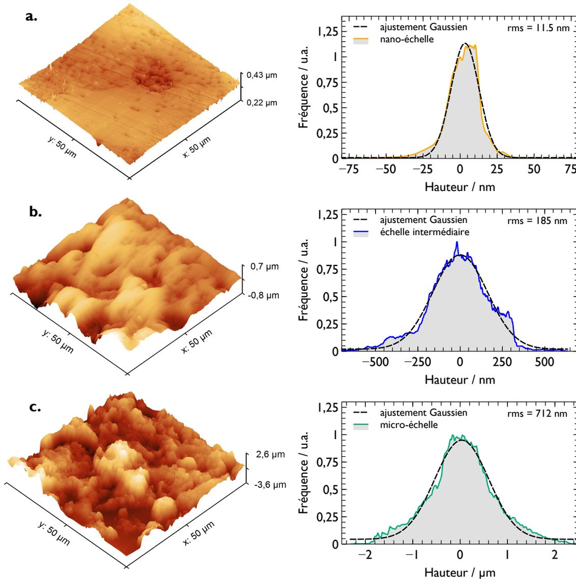
**Figure 4.5** – Topographies 3D et distributions des hauteurs pour les trois surfaces de tungstène étudiées : **a.** surface polie miroir avec une rugosité nanométrique ; **b.** surface polie avec une rugosité intermédiaire et **c.** surface exposée à un plasma avec une rugosité micrométrique. Les histogrammes de hauteurs des trois surfaces sont représentés avec des ajustements gaussiens.
