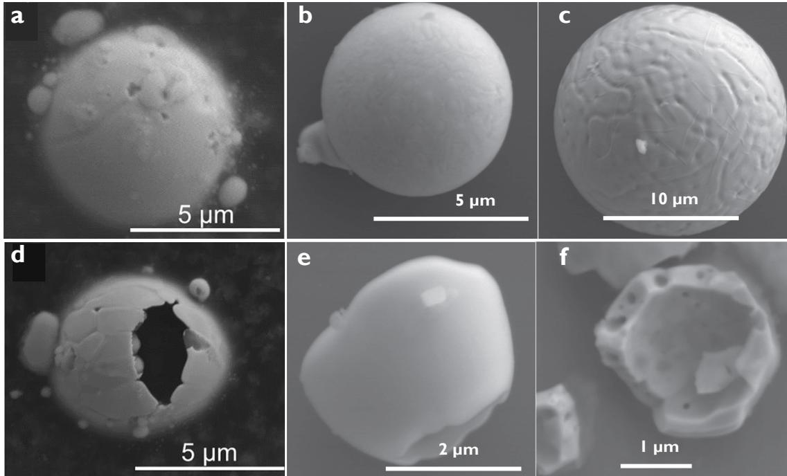
**Figure 1.12** – Particules de tungstène sphériques montrant une surface recristallisée. La topographie de la coque fermée (en **a**) et de la coque cassée (en **d**) révèle que ces particules sont creuses ([Baron-Wiechec et al., 2015](#)). D’autres exemples de ce type de particules sphériques creuses ont été trouvé par [Fortuna-Zaleśna et al. \(2017\)](#) : (**b**) et (**c**) sphères fermées, (**e**) sphère en phase de formation et (**f**) coque cassée.
