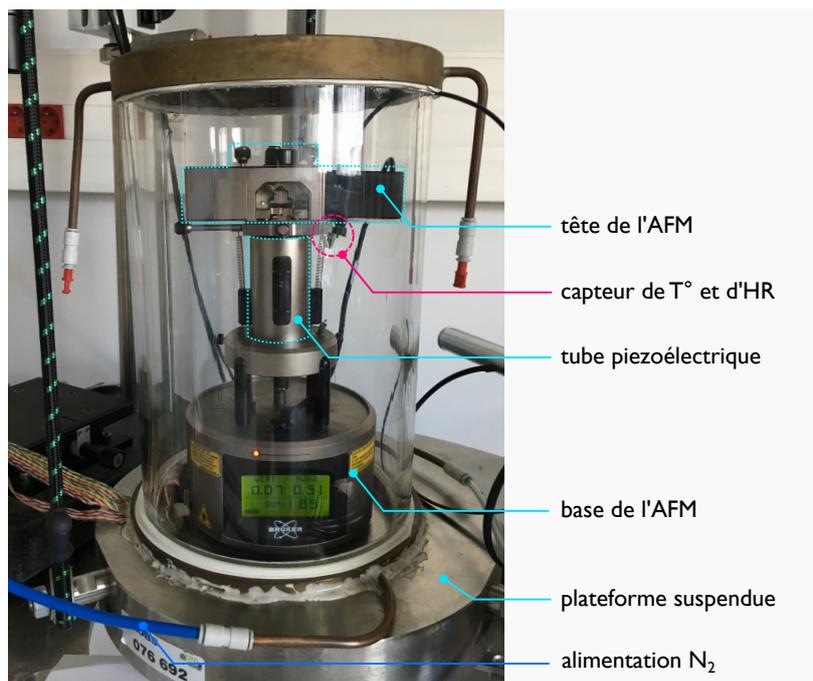
**Figure 4.14** – Photographie montrant l'AFM multimode 8 à l'intérieur de l'enceinte en verre alimentée en azote.
