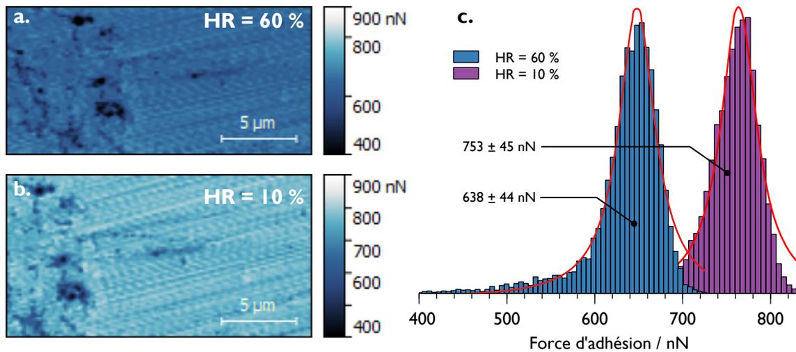
**Figure 4.18** – Exemple montrant l'influence de l'humidité sur la mesure des forces d'adhésion pour un scan réalisé sur le substrat en tungstène poli miroir avec une particule de  $3.9 \mu\text{m}$  de rayon pour deux humidités relatives (HR= 10 % sur l'image a. et HR= 60 % sur l'image b.). c. Histogrammes montrant les distributions des forces d'adhésion des deux images avec leur ajustement lorentzien.
