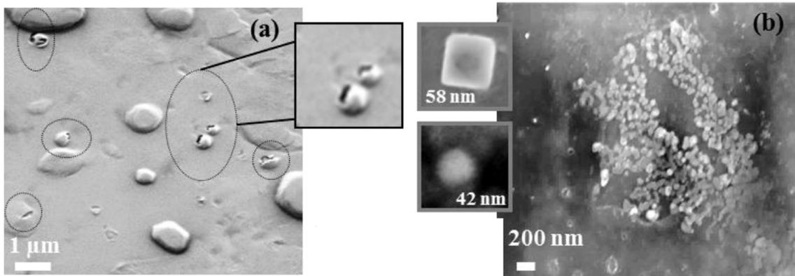
**Figure 1.9** – (a) Exemple de la formation de cloques ou *blisters* dans une surface en tungstène soumise à des ions  $H^+$  ayant une énergie incidente de 220 eV. (b) Micrographies MEB des nanoparticules de tungstène issues de l'éclatement des cloques (Ouaras et al., 2015).
