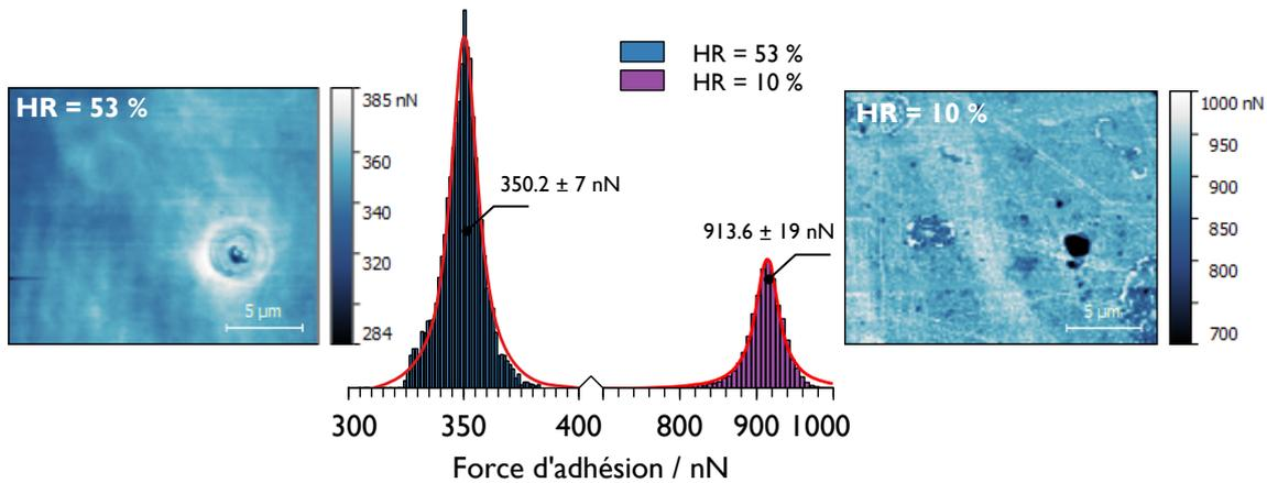
**Figure 4.15** – Exemple montrant l’influence de l’humidité sur la mesure des forces d’adhésion pour un scan réalisé sur le substrat en verre avec une particule de  $1.8 \mu\text{m}$  de rayon pour deux humidités relatives (HR = 53 % sur l’image de gauche et HR = 10 % sur l’image de droite). Les histogrammes montrent les distributions des forces d’adhésion des deux mesures avec leur ajustement lorentzien.
