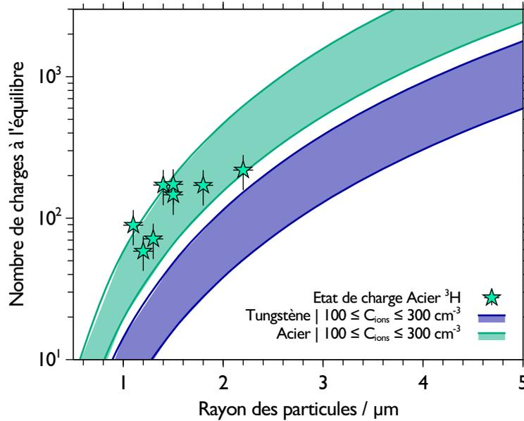
**Figure 5.20** – États de charge à l'équilibre des particules d'acier et de tungstène en fonction de la taille des particules pour les deux concentrations en ions négatifs. Les états de charges trouvés par KPFM (figure ) pour les particules d'acier tritiées sont représentés par les points étoilés.
