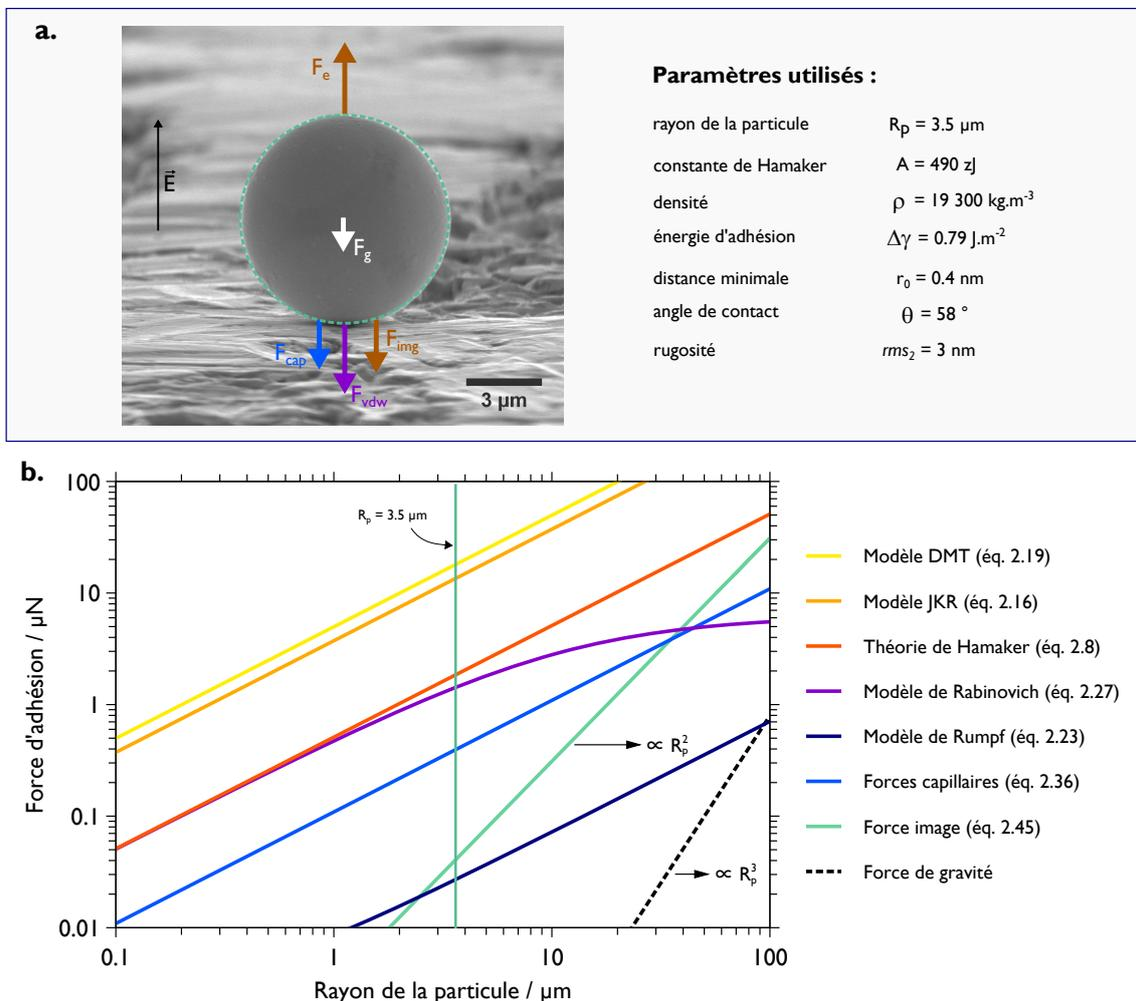
**Figure 2.25** – **a.** Image MEB montrant une particule de tungstène déposée sur une surface en tungstène. Les différentes forces qui agissent sur la particule lorsque le système est à l'air ambiant et en présence d'un champ électrique sont représentées sur l'image. **b.** Calculs des différentes forces intervenant dans l'adhésion que nous avons vues au cours du chapitre. Les paramètres principaux utilisés dans ces calculs sont reportés en **a.**
