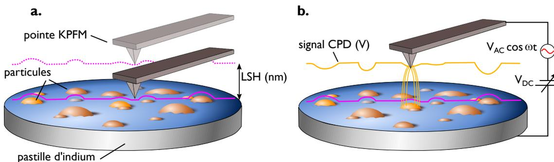
**Figure 5.11** – a. Le premier passage de la pointe permet de déterminer la topographie de l'échantillon. Ce passage peut être effectué en mode *tapping* ou en mode *PeakForce*. La pointe est ensuite relevée à une hauteur fixe (appelée LHS pour *Lift Scan Height*) qui est généralement entre 30 nm et 120 nm. b. Lors du deuxième passage, la pointe suit le profil de topographie précédemment établi pour acquérir le signal correspondant à la  $V_{CPD}$ .
