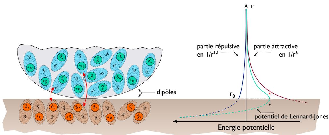
**Figure 2.2** – La force de van der Waals agit sur une très courte distance lorsque la particule est proche de la surface. A mesure que la particule se rapproche de la surface, la force de van der Waals est attractive et augmente jusqu'à un minimum  $r_0$  ou la force s'annule puis devient répulsive.
