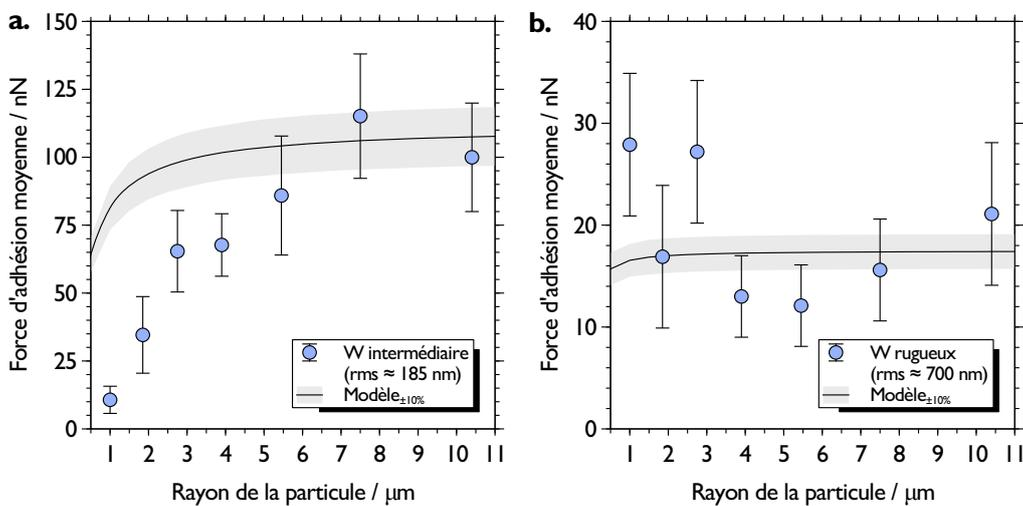
**Figure 4.26** – Force d'adhésion moyenne en fonction du rayon des particules de tungstène pour une surface de tungstène de rugosité intermédiaire (a.) et rugueuse (b.). Le modèle de Rabinovich est représenté avec une variation de 10 % sur la constante de Hamaker  $A_{\text{exp}}$  trouvée précédemment.
