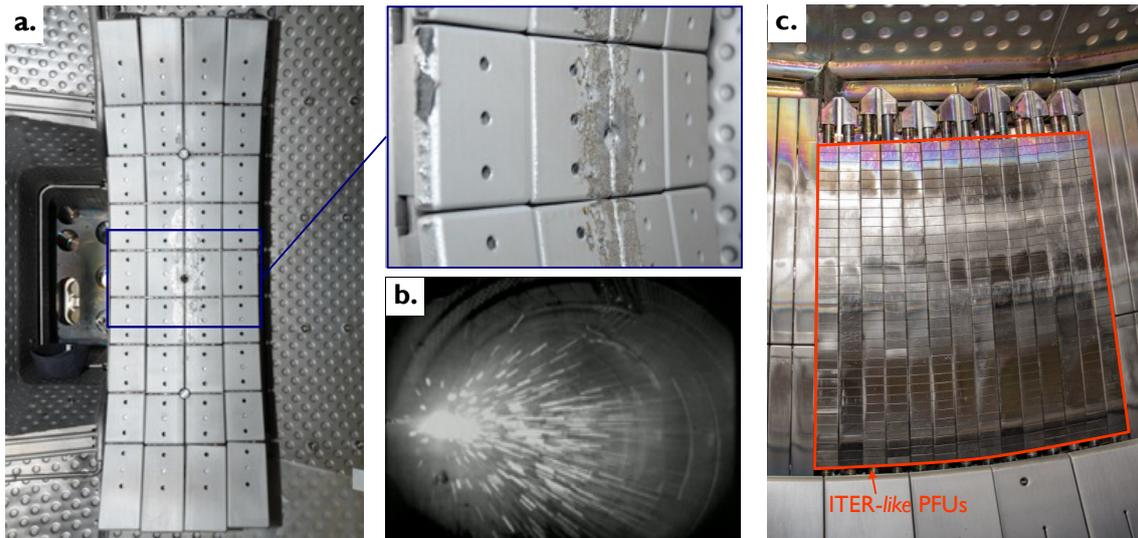
**Figure 3.9** – a. Photographie du LPA après la campagne C2 montrant les dégâts causés par les impacts d'électrons découplés. b. Image vidéo d'un impact sur le LPA. c. Photographie des aiguilles *ITER-like* du divertor de WEST. (Crédits photo CEA/IRFM)
