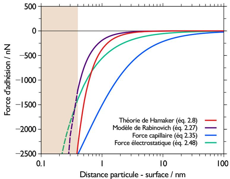
**Figure 2.21** – Évolution des forces électrostatiques, capillaires et de van der Waals en fonction de la distance entre une particule de tungstène de  $5 \mu\text{m}$  de rayon et une surface rugueuse. L'humidité relative est ici fixée à 40 % et le potentiel du substrat à 2 V.
