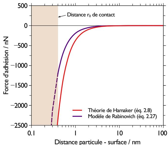
**Figure 2.11** – Forces de van der Waals calculées avec la théorie de Hamaker et le modèle de Rabinovich en fonction de la distance entre une particule de tungstène de 5 µm de rayon et une surface rugueuse.
