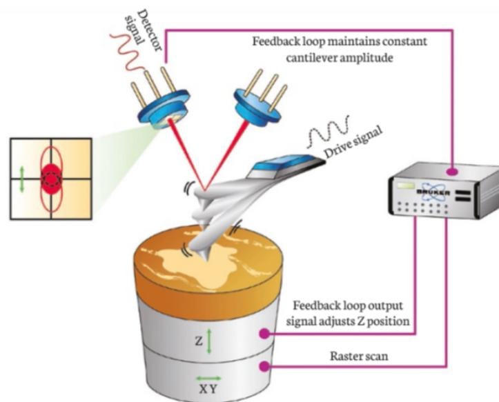
**Figure 1** – Principe de fonctionnement de l'AFM d'après [Bruker \(2017\)](#).
