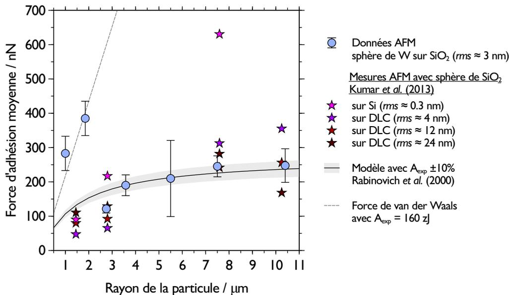
**Figure 4.23** – Forces d'adhésion moyenne en fonction du rayon des particules de tungstène pour une surface en verre. Le modèle de Rabinovich est représenté avec une variation de 10 % sur la constante de Hamaker  $A_{\text{exp}}$  trouvée expérimentalement au paragraphe 4.4.
