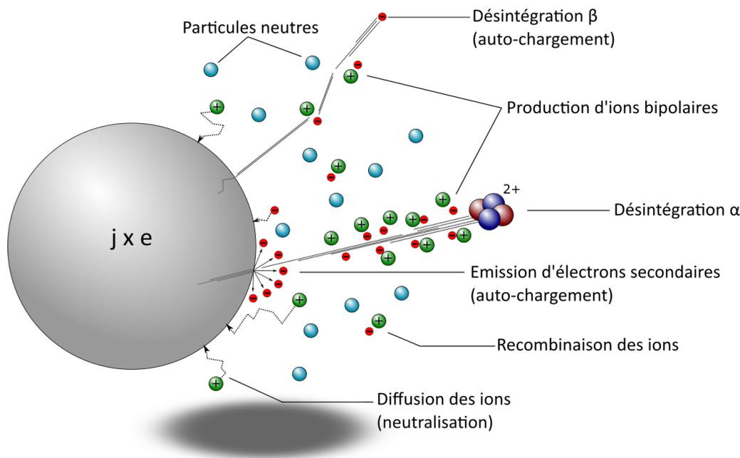
**Figure 1.14** – Processus d’auto-chargement d’une particule incluant un radioélément émetteur alpha ou béta d’après Gensdarmes et al. (2001).
