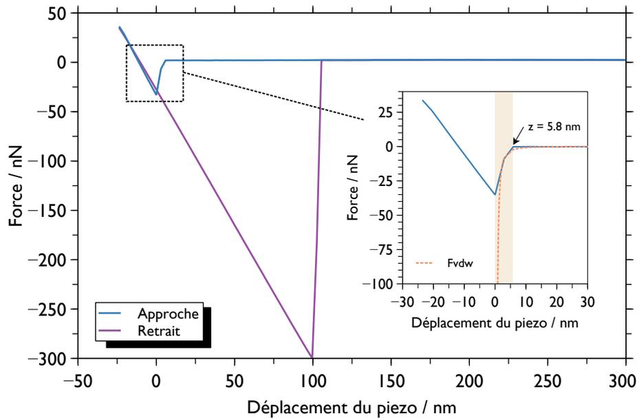
**Figure 4.19** – Exemple de mesure de la constante de Hamaker en utilisant la méthode du "saut au contact". La courbe de force a été réalisée avec une particule de tungstène de  $1 \mu\text{m}$  de rayon et la surface de tungstène poli miroir. La constante de Hamaker trouvée dans ce cas est égale à 430 zJ.
