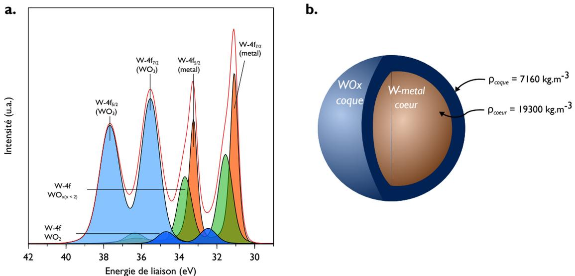
**Figure 3.16** – a. Spectre XPS des niveaux 4f du tungstène montrant une grande contribution de l'oxyde de tungstène présent à la surface des particules. b. Schéma du modèle cœur/coquille considéré pour l'estimation de la couche d'oxyde.
