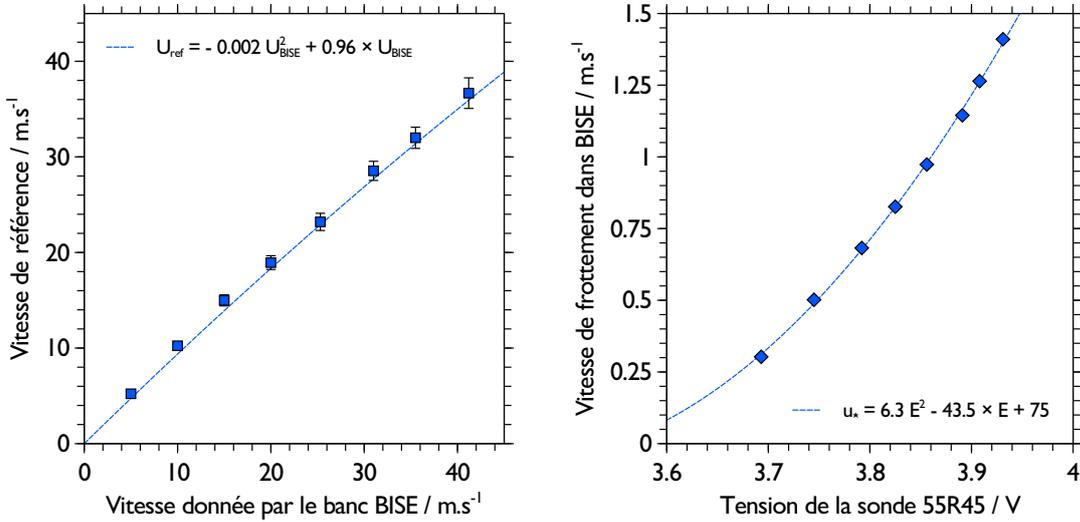
**Figure 3.4** – (à gauche) Étalonnage de la vitesse de l’écoulement dans l’installation BISE. (à droite) Étalonnage de la sonde 55R45 avec l’installation BISE.
