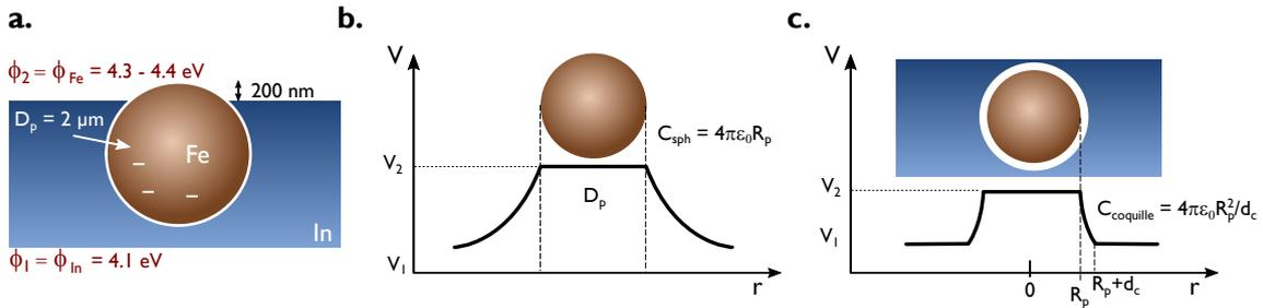
**Figure 5.16** – Équilibre des charges pour compenser les écarts de travail de sortie des matériaux : **a.** léger excédent négatif dans la particule d'acier. Illustration des deux cas limites où l'on peut calculer la capacité d'une sphère métallique : **b.** dans le vide où **c.** incrustée dans un métal.
