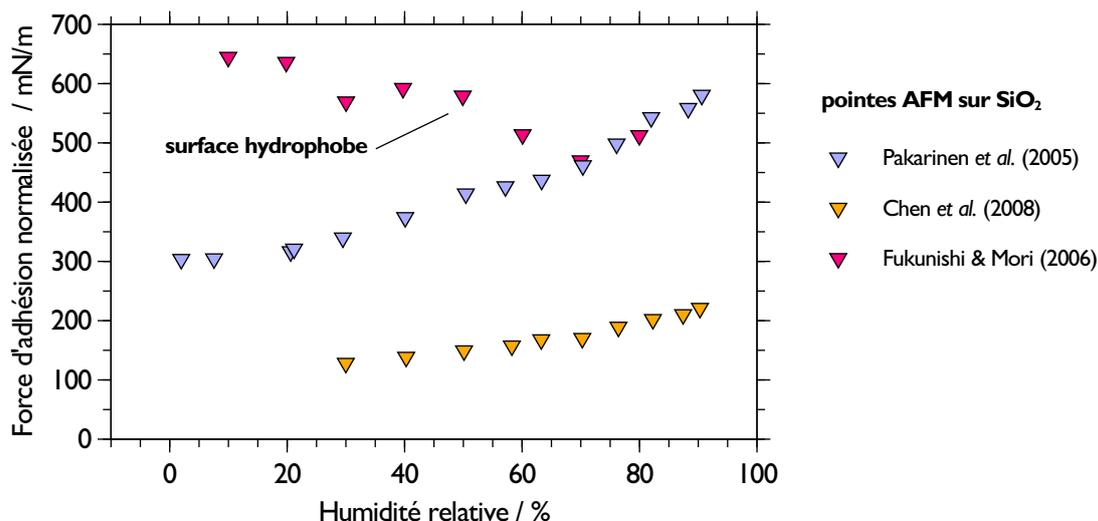
**Figure 2.15** – Évolution des forces capillaires en fonction de l’humidité relative mesurées par AFM dans plusieurs études pour des pointes AFM sur du SiO<sub>2</sub>.
