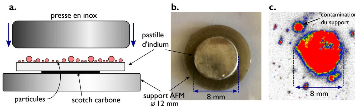
**Figure 5.6** – a. Procédure utilisée pour intégrer les particules tritiées dans une pastille d'indium. b. Photographie de la pastille d'indium fixée sur le support AFM. c. Image d'autoradiographie de la pastille d'indium montrant une activité  $\beta$  relativement homogène sur la surface de la pastille d'indium.
