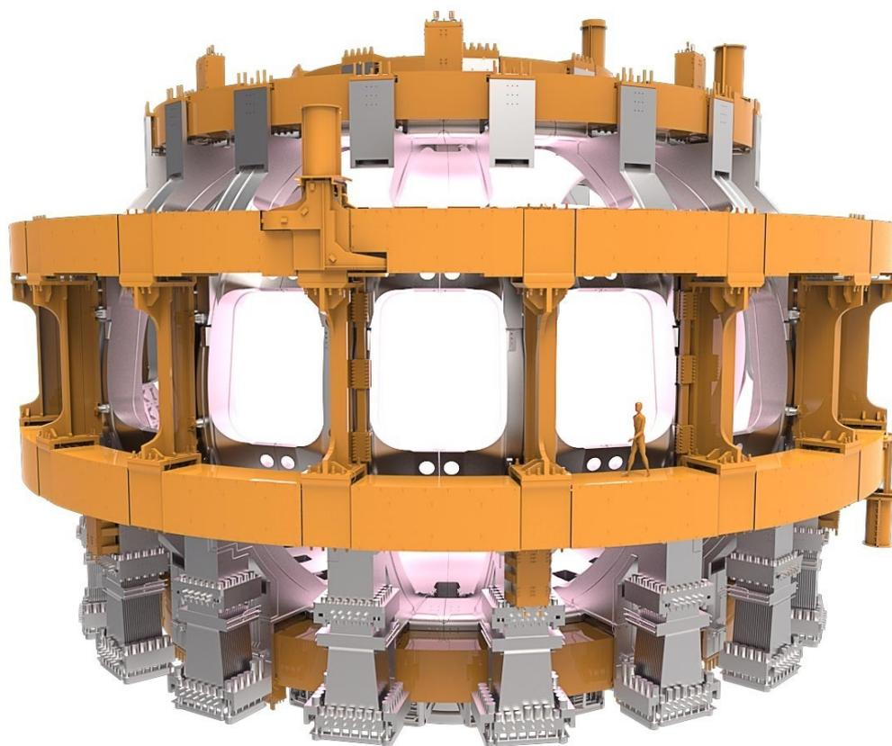
**Figure 1.1** – Représentation 3D de la chambre à vide d'ITER avec un plasma. Les bobines de champ poloidal sont colorées en orange. Sources : [www.iter.org](http://www.iter.org).
