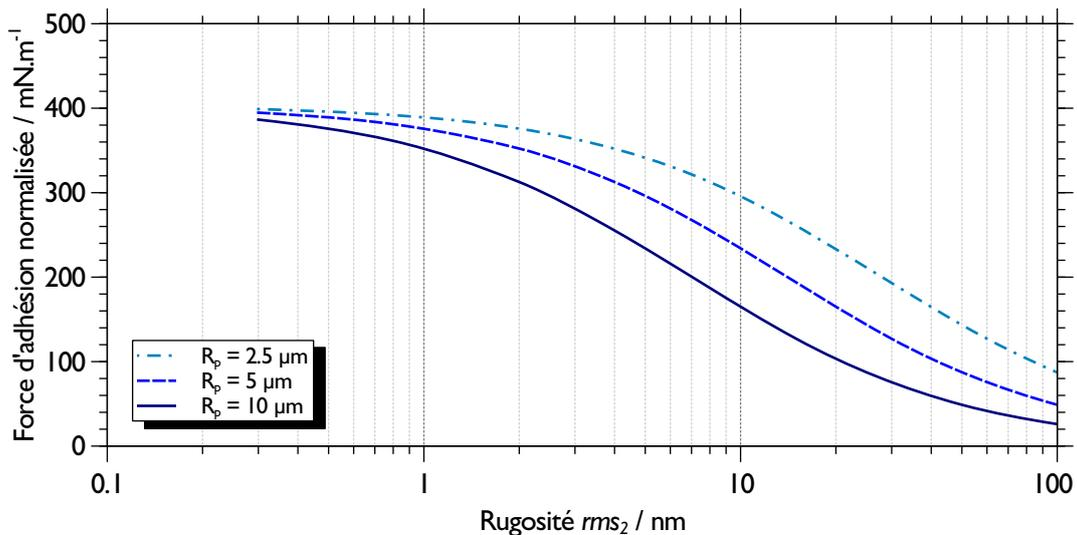
Figure 2.10 – Force d'adhésion normalisée par le rayon des particules (2.5  $\mu\text{m}$ , 5  $\mu\text{m}$  et 10  $\mu\text{m}$ ) en utilisant le modèle de Rabinovich et les mêmes paramètres que dans la figure 2.8.
