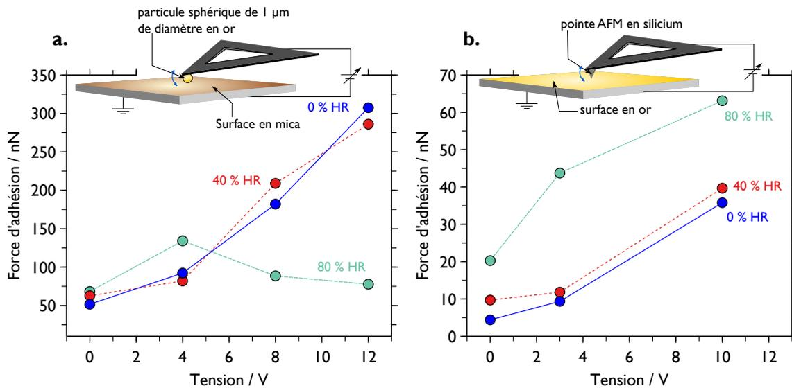
**Figure 2.16** – a. Force d'adhésion entre une surface en mica et une particule d'or sphérique de 1 μm de diamètre. b. Force d'adhésion entre une pointe AFM en silicium et une feuille d'or en fonction de l'humidité relative et du potentiel électrique appliqué sur la feuille d'or.
