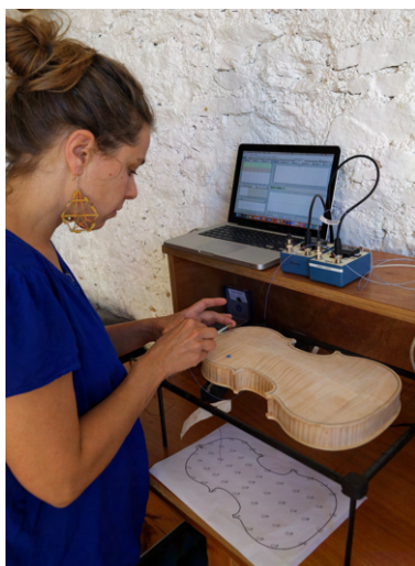
FIGURE 3.7 – Mesures vibratoires réalisées par Ruth Obermayer, une des luthières « externes », sur la caisse d'un des violons BELE.
