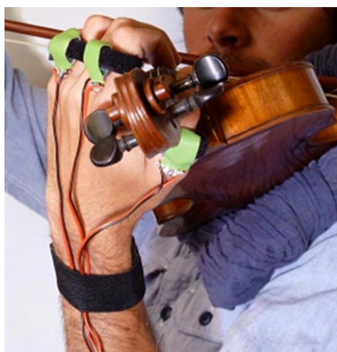
FIGURE 2.8 – Dispositif de bagues piézo-électriques permettant le masquage vibratoire dans la main gauche du violoniste.
