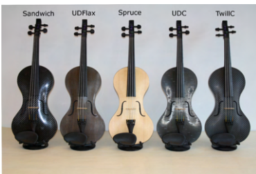
FIGURE 4.10 – Les prototypes de violon construits en cinq matériaux différents pour l'expérience. Seulement un des deux TwillC est présenté sur cette photo car les deux violons sont identiques visuellement. Crédit : Tim Duerinck.
