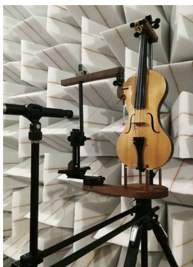
FIGURE 3.12 – Dispositif de mesure de rayonnement (dans le plan horizontal) d'un violon (ici dans la chambre anéchoïque de l'Institut d'Alembert, avec un violon qui sera présenté à la partie 4.5).
