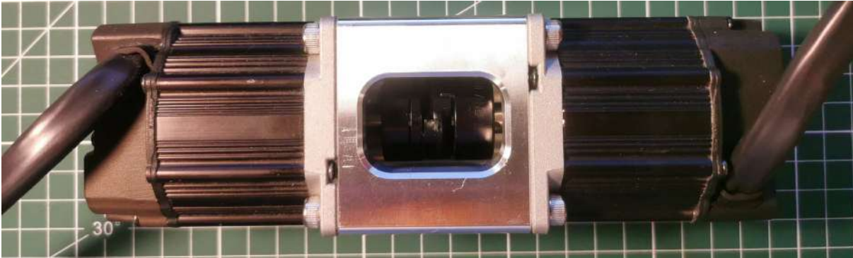
FIGURE 3.17 – Banc moteurs Teknic accouplés mécaniquement.
