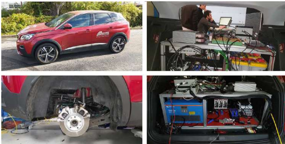
FIGURE 1.13 – Essais véhicule CBI : commande de machine low cost embarquée.
