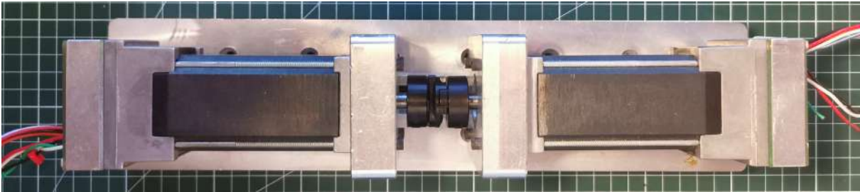
FIGURE 4.1 – Banc moteurs Hurst accouplés mécaniquement.
