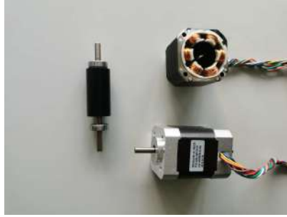
FIGURE A.4 – Photo de la machine BLDC faible coût.
