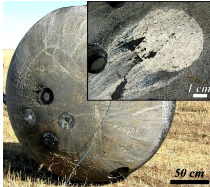
Fig. 2.3. Photo de la capsule FOTON-M3 utilisée pour la mission STONE 6 après atterrissage. En insert, zoom sur l'échantillon de chert (Foucher et al. , 2010).
